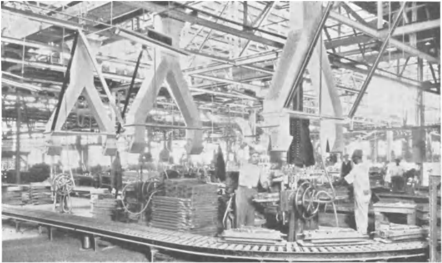
Abb. 24. Formerei mit mechanischem Sandtransport und Rollenconveyor.
