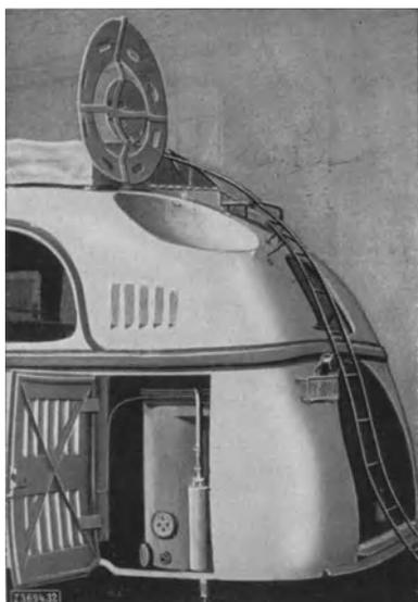
Abb. 167. Einbau eines Holzgasgenerators, Bauart Imbert, Köln, in einem windschnittigen Omnibusaufbau.
