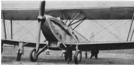
Abb. 184. Flüssigkeitskühlung. Kühler *a* braucht je nach Einbau und Fluggeschwindigkeit etwa 22 vH Motornutzleistung.
