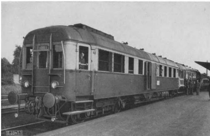
Abb. 158. Ansicht des Doble-Dampftrieb-wagens von Henschel & Sohn, Kassel, für die Lübeck-Büchener Eisenbahngesellschaft.
