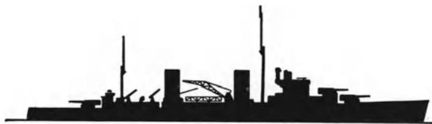
Abb. 95. Englischer 5200 t-Kreuzer „Arethusa“ mit 2 getrennten Kesselräumen. Geschwindigkeit 32,25 Knoten. Maschinenleistung nach Konstruktion 64000 WPS.
