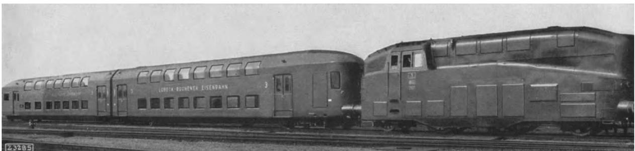
Abb. 135. Doppelstöckiger durch eine 1B1-Tenderlokomotive von Henschel & Sohn, Kassel, angetriebener Stromlinienzug für 120 km/h Geschwindigkeit der Lübeck-Büchener Eisenbahngesellschaft.
