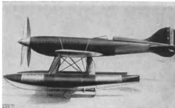
Abb. 186. Flächenkühlung. Der Kühlwiderstand der in den Schwimmern, den Schwimmerabsteifungen, im Rumpf und in den Tragflächen untergebrachten Kühler verschlingt etwa 3 vH der Motornutzleistung.
