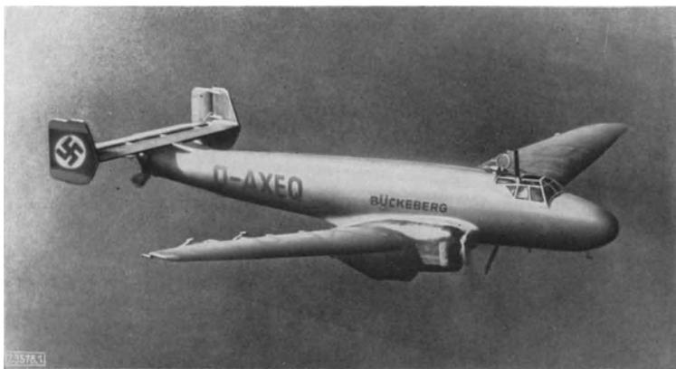
Abb. 2. Zweimotoriges Junkers-Schnellflugzeug Ju 86. Antrieb durch zwei 600 PS-Jumo 205 C-Dieselmotoren. Höchstgeschwindigkeit 315 km/h. Bietet bei Ausführung als Verkehrsflugzeug Platz für 10 Fluggäste. Dieses Flugzeug machte den 5800 km-Ohnehaltflug Dessau-Bathurst.
