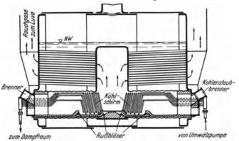
Abb. 82. Schottischer Schiffskessel mit in die Flammrohre eingebauten La Mont-Kühlelementen (Dampfer Staßfurt).
