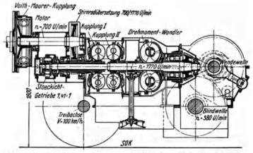
Abb. 165. Voith-Föttinger-Flüssigkeitsgetriebe für die 1400 PS-Diesellokomotive in Abb. 152—154.
