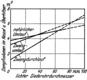
Abb. 62. Dampfvolumen im Verdampferteil und Überhitzer verschiedener Kesselarten (unter denselben Voraussetzungen wie in Abb. 61).
