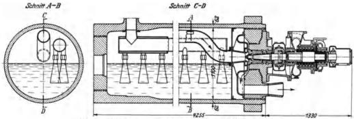
Abb. 35 und 36. Trommel und Umwälzpumpe eines Löffler-Kessels.
