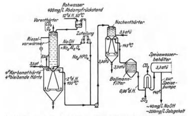
Abb. 58. Schema der chemischen Wasserreinigungsanlage bei der I.G. Farbenindustrie in Höchst. Nach C. Speidel.
