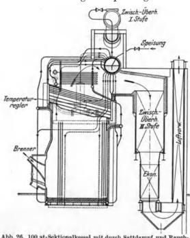
Abb. 26. 100 at-Sektionalkessel mit durch Sattdampf und Rauchgase beheiztem Zwischenüberhitzer, Ekonomiser und Röhrenluftvorwärmer der Babcock & Wilcox Co., New York. Baujahr 1929.
