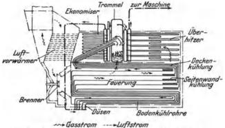
Abb. 49, Schema des Steamotive-Kessels der Babcock & Wilcox Co., New York.
