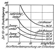
Abb. 63. Zeit bis zum Abblasen der auf 5 vH über Betriebsdruck eingestellten Sicherheitsventile eines ortsfesten Steilrohrkessels und verschiedener Schiffskessel bei plötzlicher Entlastung von Normallast auf Nullast ohne gleichzeitige Verstellung der Regelung (Betriebsdruck 100 atü, Abblasedruck 105 atü).
