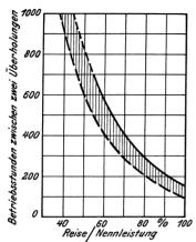
Abb. 179. Geschätzte Abhängigkeit des Verhältnisses zwischen Reiseleistung und Nennleistung eines Flugzeug-Ottomotors von der Betriebsstundenzahl zwischen 2 Überholungen. Nach Nutt.
