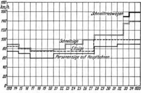
Abb 133. Höchstgeschwindigkeiten der Reisezüge der Deutschen Reichsbahn in den Jahren 1913 bis 1935. Nach Leibbrand. in Deutschland hat, haben die englischen Bahnen auch nicht das große Interesse am Bau besonders schneller Züge, in deren Einführung Deutschland ebenso wie mit den im regelmäßigen Bahnverkehr erreichten Höchstgeschwindigkeiten an der Spitze marschiert.
