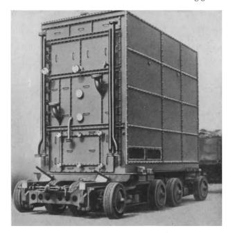
Abb. 67. 5 bis 6 t/h-La Mont-Kessel für Dampf von 13 at, 250° auf dem Transport.
