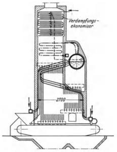
Abb. 22. Borsig-Eintrommelsteilrohrkessel,
