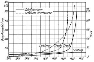
Abb. 96. Höchstwerte von Druck und Leistung bei Schiffs- und Landkesseln seit 1900.
