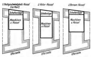
Abb. 90. Vergleich des Grundflächenbedarfes der Entwürfe von drei Firmen für ein gasgefeuertes Heizkrattwerk von 100 Millionen kcal/h Anschlußwert der Berliner Städt. Elektrizitätswerke.
