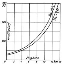
Abb. 191. Kraftbedarf des Gebläses bei 55 und 65 vH Wirkungsgrad in Abhängigkeit von der Flughöhe bei freiem Auspuff der Kesselabgase (hinter Kessel ist keine Gasturbine zum Antrieb des Gebläses geschaltet) und daher mit der Flughöhe fallendem Druck im Feuerraum des Kessels.
