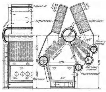
$Abb.\ 101\ und\ 102.\ Yarrow-Kessel\ des\ Schnelldampfers\ ,, Queen\ Mary ``für\ Frischdampf\ von\ 28\ at,\ 370°.$
