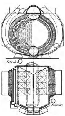
Abb. 99 und 100. 75/90 t/h-Johnson-Schiffskessel von Clarke, Chapman & Co., Gateshead on Tyne für Dampf von 21 at, 330°; Keselheizfläche = 840 m², Überhitzerheizfläche = 168 m².
