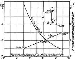
Abb. 68. Einfluß der spezifischen Feuerraumbelastung auf die Abmessungen eines Feuerraumes.
