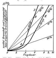
Abb. 194. Abhängigkeit des wirtschaftlichen Kesselwirkungsgrades von der Flugdauer für zwei Kessel mit Luftvorwärmern, die für 30 bzw. 60 m/s Luft- und Rauchgasgeschwindigkeit ausgelegt sind.
