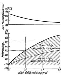
Abb. 181. Leistungsgewinn von Junkers-Dieselmotoren durch verbesserte Spülung und verbesserte Auflader. Nach Gasterstädt.
