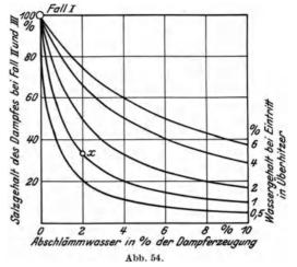
Abb. 53. Bei Schaltung eines Zwangdurchlaufkessels nach Fall II (Abb. 55) zulässiger Salzgehalt des Speisewassers ausgedrückt in einem Vielfachen des bei Fall I zulässigen Wertes in Abhängigkeit von der Abschlämmwassermenge und dem Dampfgehalt des zum Überhitzer strömenden Sattdampfes.
