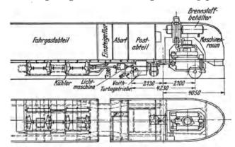
Abb. 150. Gesamtanordnung der Maschinenanlage des dreiteiligen Schnelltriebwagens der Deutschen Reichsbahn.
