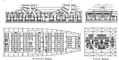
Abb. 124—127. Vergleich des Raumbedarfes der Penhoët-Kessel des Schnelldampfers "Normandie" mit gleich leistungsfähigen Velox-Kesseln.
