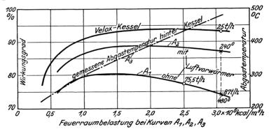
Abb. 72. Gemessener (Kurve  $A_2$ ) und auf eine Abgastemperatur bei Höchstlast (87 t/h) von  $240^\circ$  umgerechneter Wirkungsgrad (Kurve  $A_2$ ) eines ölgefeuerten Johnson-Schiffskessels und gemessener Wirkungsgrad eines Velox-Kessels (bei einer Dampferzeugung von 25 t/h betrug die Feuerraumbelastung des Velox-Kessels etwa 6 Millionen kcal/m³ h).
