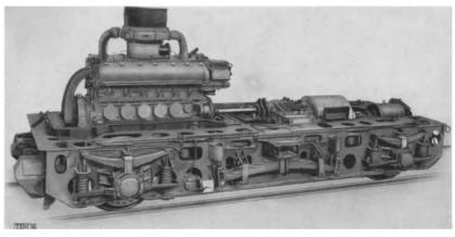
Abb. 166. Triebdrehgestell mit Dieselmotor und Voith-Föttinger-Getriebe für den dreiteiligen Schnelltriebwagen in Abb. 147—150.
