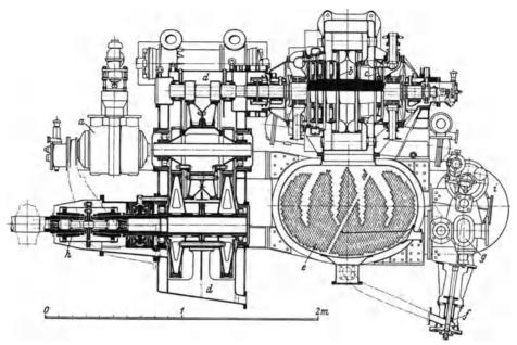
Abb. 115. Wagner-Getriebeturbine der Zollwachtschiffe "Brummer" und "Bremse" mit einer Höchstleistung von rd. 1600 PS. a Hochdruckturbine, b Niederdruckturbine, c Rückwärtsturbine, d Zahnradgetriebe, e Kondensator und Ölkühler, f Kondensatpumpe, g Schmierölpumpe, h Zahnkupplung, g Kühlwasserpumpe.
