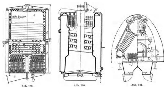
Abb. 159. Doble-Kessel für einen Dampftriebwagen von Henschel & Sohn. Kassel.
