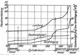
Abb. 92. Steigerung von Verdrängung, Geschwindigkeit und Maschinenleistung von Fahrgast- und Kriegsschiffen seit 1840.
