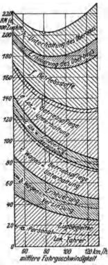
Abb. 138. Kosten einer Schnelizug-Reisezugfahrt bei verschiedenen Fahrgeschwindigkeiten. Nach Leibbrand.
