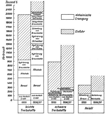
Abb. 6. Übersicht über die ungefähre Deckung des deutschen Bedarfes an Treib- und Heizöl. Nach Oetken.
