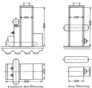
Abb. 85 und 86. Hauptabmessungen von 2 für ein Spitzenkraftwerk mit sehr kurzer Anfahrdauer bestimmten 30 at-Zwangumlaufkesseln für 26  $\rm t/h$  höchste Dampfleistung.
