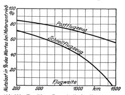
Abb. 202. Ungefährer Prozentsatz der Nutzlast bei einem dampfangetriebenen Post-bzw. Schnellflugzeug von den bei motorischem Antrieb erreichbaren Werten in Abhängigkeit von der Länge der Flugstrecke.
