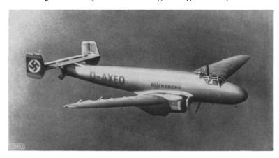
Abb. 2. Zweimotoriges Junkers-Schnellflugzeug Ju 86. Antrieb durch zwei 600 PS-Jumo 205 C-Dieselmotoren. Höchstgeschwindigkeit 315 km/h. Bietet bei Ausführung als Verkehrsflugzeug Platz für 10 Fluggäste. Dieses Flugzeug machte den 5800 km-Ohnehaltflug Dessau-Bathurst.
