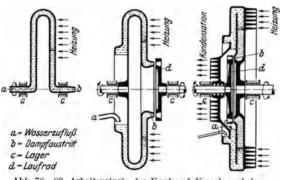
Abb. 78-80. Arbeitsprinzip des Vorkauf-Kessels und der Hüttner-Turbine.
