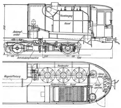
Abb. 162 und 163. Vorschlag der Friedrich Krupp A.G. für das Preisausschreiben des Rheinisch-Westfälischen Kohlensyndikates-Kohlengefeuerter Dampftriebwagen mit 2 dreizylindrigen, je eine Achse über Vorgelege antreibenden Dampfmaschinen.
