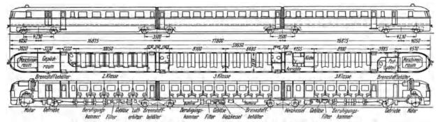
Abb, 147-149. Dreiteiliger Schnelltriebwagenzug der Deutschen Reichsbahn mit Dieselmotorenantrieb.
