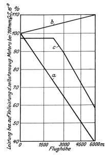
Abb.180. Leistung eines Flugzeug-Ottomotors in vH der Volleistung des selbstansaugenden Motors in Abhängigkeit von der Flughöhe. Nach Bureau of Standards und O. Kurtz.
