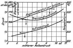
Abb. 19. Aufladedruck, Abgastemperatur und Brennstoffverbrauch eines MAN-Sechszylinder-Dieselmotors mit Abgasturbogebläse bei verschieden starkem Aufladen. Nach Pflaum. Der Motor, der wahrscheinlich mit dem Motor in Abb. 151 identisch ist, leistet ohne Aufladen bei 700 U/min 700 PS.
