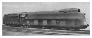
Abb. 134. 2 C 2-Stromlinienlokomotive der Borsig Lokomotiv-Werke, Schnellste Dampflokomotive der Welt.
