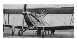
Abb. 184. Flüssigkeitskühlung. Kühler a braucht je nach Einbau und Fluggeschwindigkeit etwa 22 vH Motornutzleistung.
