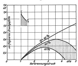
Abb. 71. Zur Geschwindigkeitserzeugung der die Heizfläche durchströmenden Rauchgase verfügbares Druckgefälle bei 55, 60 und 65 vH Wirkungsgrad von Kompressor und Gasturbine in Abhängigkeit vom Verbrennungsdruck bei Dampfkesseln mit aufgeladenem Feuerraum (Temperatur der in die Gasturbine eintretenden Rauchgase 500°).
