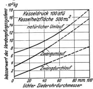
Abb. 61. Wasserwert des Verdampferteils verschiedener Kesselarten mit betriebsmäßiger Wasserfüllung. (Kesseldruck 100 atü, Verdampfungsheizfläche 500 m², lichter Durchmesser der Obertrommel bei Zwangumlauf und natürlichem Umlauf 1200 mm, lichter Durchmesser der Untertrommel bei natürlichem Umlauf 850 mm, zylindrische Länge der Trommeln 3100 mm.)
