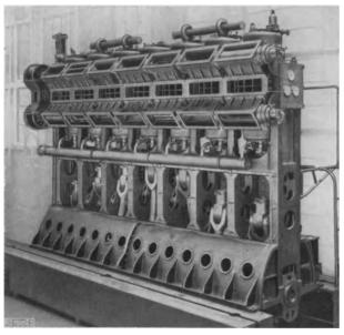
Abb. 15. Ansicht eines der Hauptantriebs-MAN-Dieselmotoren für den kleinen Kreuzer "Leipzig". Verschlußdeckel, Spül- und Auspuffleitungen sind abgenommen. Zahl der Zylinder 7, Leistung 3100 PS, Drehzahl 600; Literleistung 7,4 PS/l.
