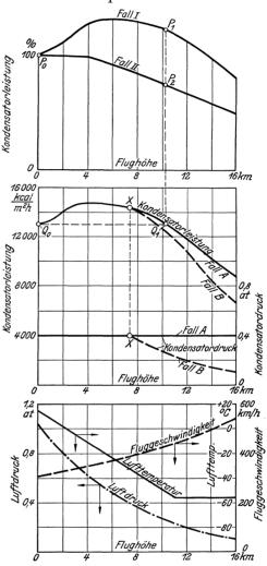
Abb. 195. (Unten.) Fluggeschwindigkeit bei konstanter Schraubenleistung und Luftdruck und -temperatur bei verschiedener Flughöhe.
