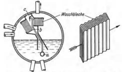
Abb. 32 und 33. In die Obertrommel eines Sektionalkessels eingebauter Dampfwäscher der Babcock & Wilcox Co., New York.
