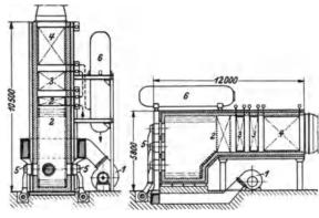
Abb. 64 und 65. Ortsfester 115 atū-Zwangumlauf-Hochgeschwindigkeitskessel in stehender und in liegender Bauart (Dampfleistung 85 t/h, Dampftemperatur 500°, Wirkungsgrad 85,5 vH). I Unterwindgebläse, 2 Verdampfungsheizfläche, 3 Überhitzer, 4 Ekonomiser, 5 Übrenner. 6 Kesseltrommel.
