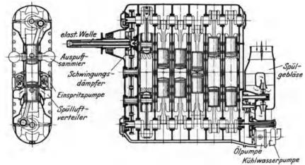
Abb. 175 und 176. Sechszylinder-Jumo-205-Junkers-Flugzeugdieselmotor. Höchste Drehzahl 2200 U/min, höchste Leistung 700 PS, Leistungsgewicht 0,73 kg/PS.
