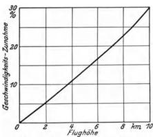
Abb. 188. Zunahme der Fluggeschwindigkeit mit steigender Flughöhe bei gleichbleibender nutzbarer Schraubenleistung. Nach Johnson und Gagg.
