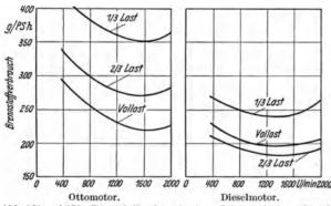
Abb. 169 und 170. Brennstoffverbrauch eines Otto- und eines Dieselmotors für Kraftwagen bei verschiedenen Lasten. Nach Preuß.
