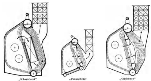
Abb. 29-31. Schema der Wagner-Kessel auf den Schnelldampfern "Scharmhorst", "Tannenberg" und "Gneisenau".
