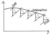
Abb. 81. Expansionsverlauf in der Hüttner-Turbine. Nach Hüttner.
