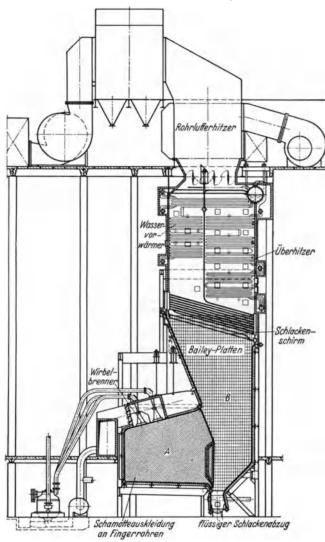
Abb. 28. 90 at-Einzug-Sektionalkessel mit Regulierung der Überhitzung durch Rauchgasklappen und Schmelzkammerfeuerung für 260 t/h Dampferzeugung der Babcock & Wilcox Co., New York.
