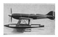
Abb. 186. Flächenkühlung. Der Kühlwiderstand der in den Schwimmern, den Schwimmerabsteifungen, im Rumpf und in den Tragflächen untergebrachten Kühler verschlingt etwa 3 vH der Motornutzleistung.
