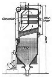
Abb. 27. 48 at-Dreizug-Sektionalkessel mit Kohlenstaubfeuerung für 80 t/h Dampferzeugung der Babcock &Wilcox Ltd., London.
