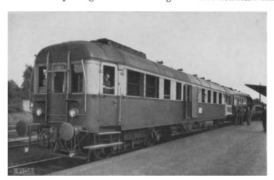
Abb. 158. Ansicht des Doble-Dampftriebwagens von Henschel & Sohn, Kassel, für die Lübeck-Büchener Eisenbahngesellschaft.
