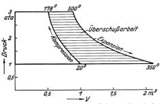
Abb. 69. Prinzipskizze für den Leistungsüberschuß einer durch die Abgase eines Kessels durchströmten Gasturbine über den Kraftbedarf des Aufladegebläses bei verlustloser adiabatischer Kompression und Expansion.
