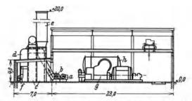
Abb. 87—89. Spitzenkraftwerk mit 2 Turbinen von je 12500 kW Leistung und 2 Zwangumlauf-Hochgeschwindigkeitskesseln. Entwurf AEG, a durch Dampfturbine gemeinsam angetriebener Hilfsmaschinensatz, b Gebläse für Verbrennungsluft, c Luftvorwärmer, d Hochgeschwindigkeitskessel, e Schornstein, f Hilfsmaschinensatz zum Anfahren der Kessel, g Turbine, h Konsendator, i Speisewasserbehälter.
