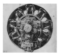
Abb. 198. Neuzeitlicher Sternmotor mit Ringhaube. a Ringhaube, b nachgiebige Befestigungsbügel zwischen Zylindern und Ringhaube, e Gasanlasser, d Ladedruckregler, e Gemischregler, f Schwungradanlasser.
