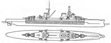
Abb. 93 und 94. Italienischer 10000 t-Kreuzer "Trieste" mit 2 getrennten Kesselräumen. Geschwindigkeit 35,5/38,7 Knoten, Maschinenleistung nach Konstruktion 150000 WPS.
