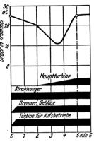
Abb. 83. Anfahren eines Momentan-Spitzenwerkes mit Zwangumlauf - Hochgeschwindigkeitskesseln, Bauart AEG-Dr. Münzinger.
