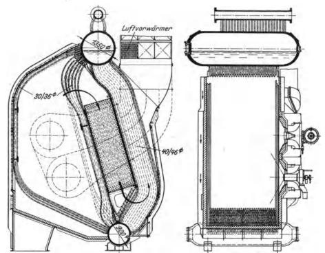
Abb. 110 und 111. 36 t/h-Wagner-Kessel des Schnelldampfers "Scharnhorst" für Frischdampf von 50 at, 470°.
