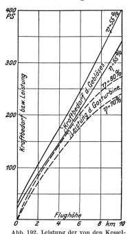
Abb. 192. Leistung der von den Kesselabgasen durchströmten Gasturbine bei 70 und 80 vH Wirkungsgrad und Kraftbedarf des von ihr zum Verdichten der Verbrennungsluft angetriebenen Gebläses bei 55 und 65 vH Wirkungsgrad in Abhängigkeit von der Flughöhe bei Arbeiten mit einem konstanten Druck im Feuerraum von 1,1 ata, Fall I. Voraussetzungen: Wirkungsgrade sind bezogen auf adiabatische Kompression
