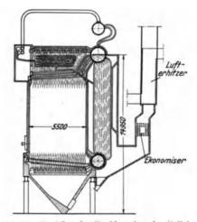
Abb. 24. 45 at-Lopulco-Strahlungskessel mit Eckenbrennern für 75 bis 95 t/h Dampferzeugung der International Combustion Ltd., London.
