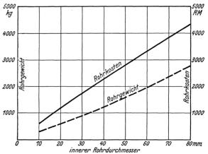
Abb. 66. Gewicht und Kosten der zum Übertragen von 1 Million kcal/h bei 100 at Kesseldruck erforderlichen Siederohre bei verschiedenem innerem Durchmesser der Rohre.  $\varDelta~t=400^{\circ},$
