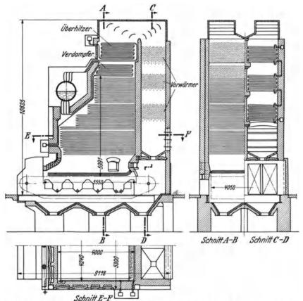
Abb. 42-44. 40 t/h-La Mont-Kessel für Dampf von 46 atü, 450° der Deutschen Werke, Kiel.
