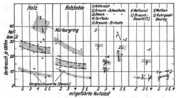
Abb. 168. Brennstoffverbrauch der an der "Versuchsfahrt mit heimischen Brennstoffen 1935" beteiligten Lastkraftwagen. Nach E. Schulz.
