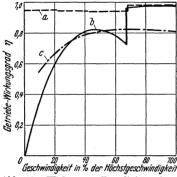
Abb. 18. Wirkungsgradkennlinien eines mechanischen Stufengetriebes (a), eines hydraulischen Getriebes (b) und einer elektrischen Kraftübertragung (c).
