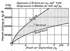
Abb. 70. Leistungsüberschuß der Gasturbine bei Kesseln mit aufgeladenem Feuerraum und Antrieb des Aufladekompressors durch eine von den Kesselabgasen durchströmte Gasturbine in Abhängigkeit vom Gasdruck vor der Gasturbine p $_T$  bei Expansion der Gase in der Turbine auf 1 ata bei verlustloser adiabatischer Kompression und Expansion.
