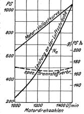
Abb. 17. Brennstoffverbrauch der 900/1200 PS-Dieselmotoren des Luftschiffes Hindenburg. Nach Sturm.
