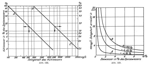
Abb. 122. Bei einem nicht abgeschlämmten Kessel zur Erhöhung des Salzgehaltes des in den Kessel gelangenden Wassers von 5 auf 100 mg/l erforderlicher Kühlwassereinbruch ins Speisesystem in vH der Speisewassermenge in Abhängigkeit vom Salzgehalt des Kühlwassers.
