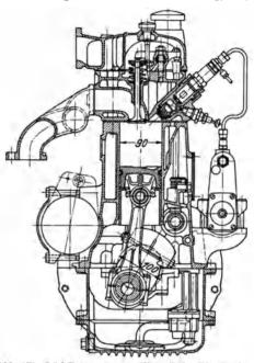
Abb. 171. 2,6 l-Personenwagen-Vierzylinder-Dieselmotor von Daimler-Benz. Bohrung 90 mm, Hub 100 mm, Verdichtungsverhältnis 20, Leistung bei 3000 U/min 45 PS.
