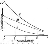
Abb. 60. Kraftbedarf der Speisepumpe und der Umwälzpumpe von 130 at-Löffler-Kesseln bei Teillast. Nach Löffler. Sp Speisepumpe, U Umwälzpumpe, N beide Pumpen zusammen.
