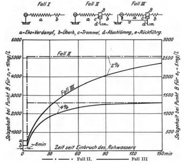
Abb. 55. Zeitlicher Anstieg des Salzgehaltes des bei Punkt B der Schaltungsskizze in die Abscheidetrommel eines Zwangdurchlaufkessels gelangenden Wassers bei Fall II und III bei einem Salzgehalt des Speisewassers von 5 bzw. 10 mg/l und einer Abschlämmwassermenge von 2 und 4 vH der Speisewassermenge. In Fall III ist vorausgesetzt, daß 10 vH der normalen Speisewassermenge durch Rückführung e in eine Stufe der Speisepumpe zurückströmen.
