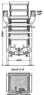
Abb. 118 and 119. 21 t/h-S u1z e'r-Einrohrkessel des Dampfers "Kertosono" für Frischdampf von 60 at,  $375^{\circ}$ .
