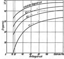
Abb. 164. Einfluß des Frischdampfdruckes auf den Wärmeverbrauch von Dampflokomotiven (Ersparnis gegenüber einer 16 at-Einheitslokomotive)<sup>1</sup>. Nach Najork und Wichtendahl.
