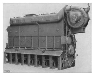
Abb. 151. 920/1400 PS-MAN-Hauptdieselmotor mit Büchi-Aufladegebläse (rechts oben) für die in Abb. 152-154 dargestellte 1400 PS-Diesellokomotive.
