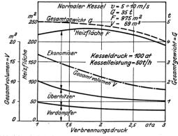
Abb. 74. Einfluß des Druckes im Feuerraum eines Kessels auf Größe, Gesamtgewicht und Gesamtvolumen der zum Erzielen derselben Abgastemperatur erforderlichen Heizfläche bei gleichem zusätzlichen Kraftbedarf des Gebläses.
