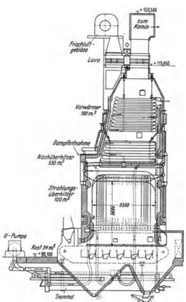
Abb. 34. 35/45 t/h-MAN-Löffler-Kessel für Dampf von 100 at, 500° im Werk der I. G. Farbenindustrie, Höchst.
