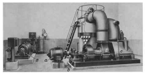
Abb. 8. Ansicht eines Velox-Kessels. a Elektromotor, b Zahnradvorgelege, c Gasturbine, d Kompressor.
