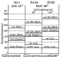
Abb. 12. Rauchgastemperaturen an verschiedenen wichtigen Stellen bei einem 25 atti- und bei zwei 100 atti-Kesseln bei gleicher Abgastemperatur (200°).
