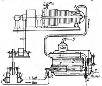
Abb. 10. Vorschlag einer durch einen Kompressor, der durch die Kesselabgase angetrieben wird, aufgeladenen Brennkammer aus dem Jahre 1904.
