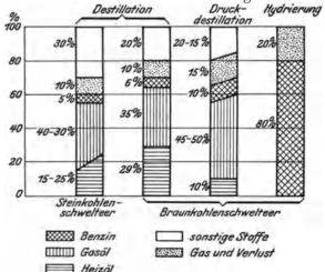
Abb. 5. Übersicht über die bei verschiedenen Verarbeitungsverfahren von Schweiteer anfallenden Produkte. Nach Oetken.
