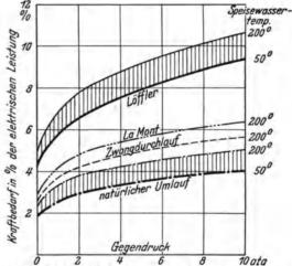
Abb. 59. Kraftbedarf der Speise- und der Umwälzpumpe in vH der erzeugten elektrischen Leistung bei einem Anfangszustand des Dampfes von 130 at, 500° und verschiedenem Gegendruck der Hauptturbine bei 50° und 200° Eintrittstemperatur des Speisewassers. Der Kraftbedarf ist in vH von der elektrischen Leistung angegeben, die der vom Kessel erzeugte Dampf bei Expansion von 130 at, 500° auf den an der Abszisse angegebenen Gegendruck in der Hauptturbine erzeugten würde.
