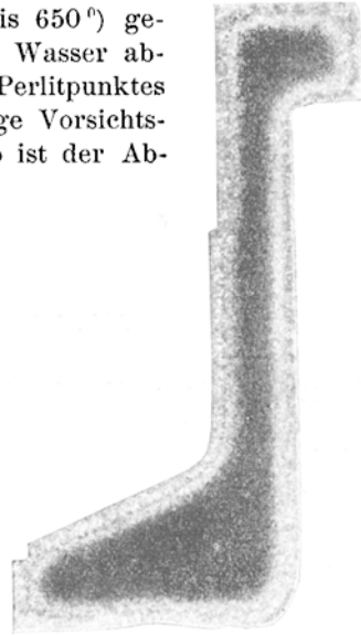
Abb. 105. Im Einsatz gekohlte Lagerschale (Querschnitt).
