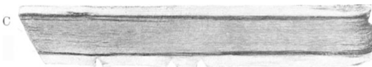
Abb. 92. Querschliff aus einem Schiffsblech.
