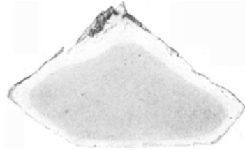
Abb. 108. Durch zu langes Glühen oberflächlich entkohltes Stahlgußstück.
