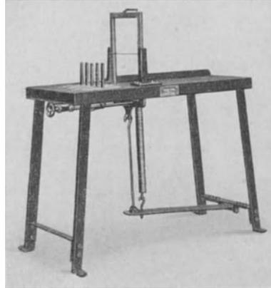
Abb. 134. Einfache Seifenstrangzerschneidemaschine (Weber & Seeländer, Helmstedt).
