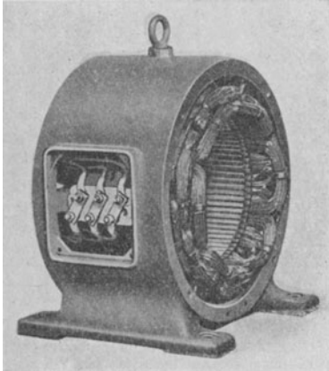
Abb. 175. Drei-Etagen-Wicklung mit gleichmäßig verteilten Wicklungsköpfen
