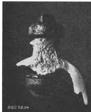
Bbb. 8. Motorisolator nach der Steinwurfprüfung. (2000 Treffer).
