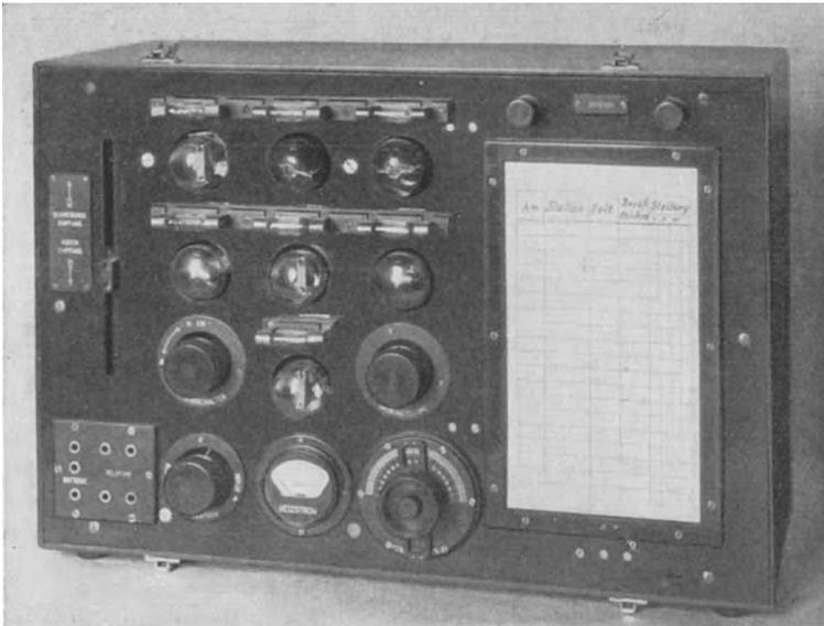
Abb. 87. Sieben-Röhren-Rahmenempfänger von P. Floch, W. de Colle und E. Nesper.
