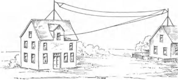
Abb. 131. Ungünstige Anordnung einer L-Antenne.
