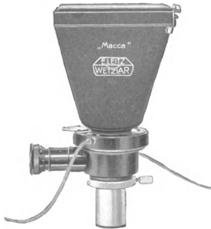
Abb. 85. „Macca“, mikrophotographischer Aufsatz von Leitz.
