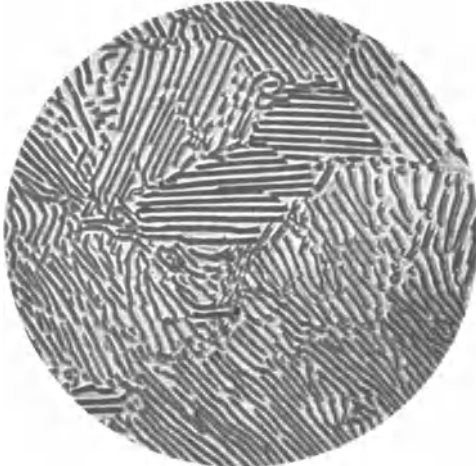
Abb. 62. Eisenguß 600:1. \frac{1}{7} -a-Ölimmersion. Periplanokular 8 \times . (E. Leitz.)
