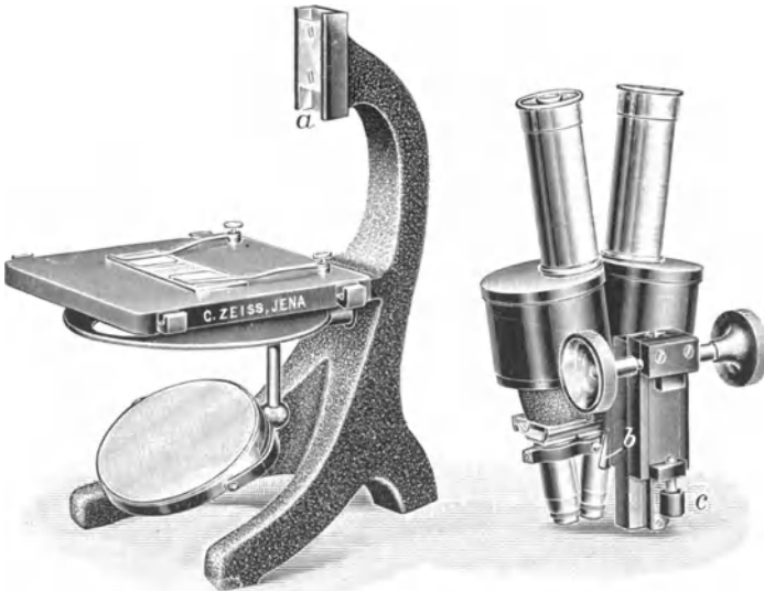
Abb. 40. Stereoskopisches Mikroskop von Zeiß mit Tisch und unter diesem angebrachter drehbarer Schwarz-Weiß-Scheibe (zur Betrachtung mit auffallendem Licht). Der Doppeltubus kann leicht herausgenommen und an einem tischlosen Stativ angebracht werden, wodurch Betrachtung von Schalen oder Gegenständen unmittelbar in auffallendem Licht möglich wird („Dermatoskop“). Etwa \frac{1}{4} natürlicher Größe.
