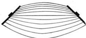
Abb. 61. Feldlinienverlauf bei geneigten Elektroden.
