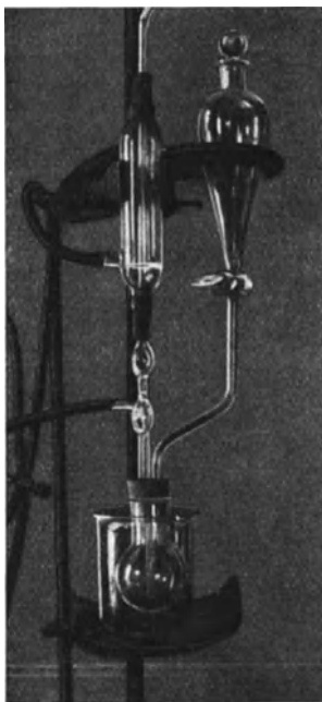
Abb. 165. Apparat zur Glycerinbestimmung nach Fachini und Somazzi.
