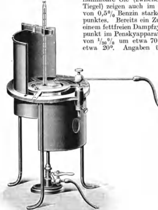
Abb. 36a. Flammpunktprüfer für Maschinen- und Zylinderöle nach Marcussen.
