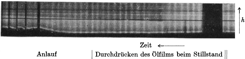
Abb. 109. Verlagerung (Höhenbewegung h ) beim Auslauf mit dickflüssigem Öl.
