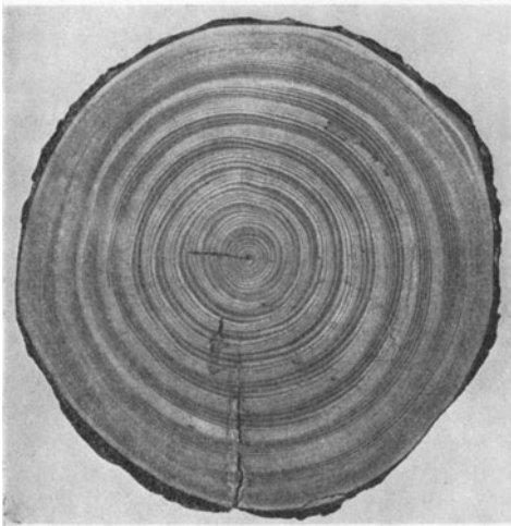
Abb. 13 b. Fichtenstammscheibe aus Schweden mit spiralförmiger Rotholzanzordnung. Nach Prof. FABRICIUS.
