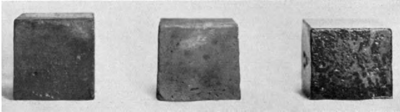
Abb. 60. Zementwürfel aus gewöhnlichem Portlandzement nach einer Lagerung von 4 Wochen in Leitungswasser (links), destilliertem Wasser (Mitte) und kohlensäurehaltigem Wasser (rechts).
