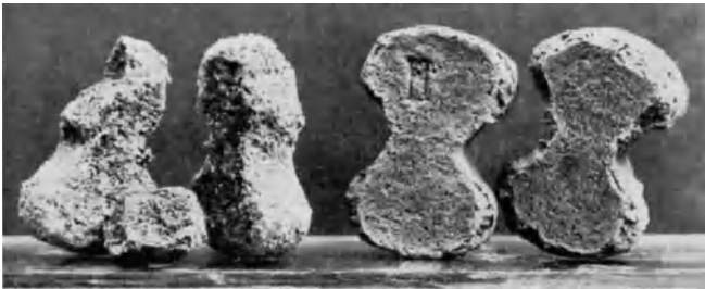
Abb. 68. Normenkörper aus hochwertigem Portlandzement nach einer Lagerung von 80 Tagen in 15% iger Ammonsulfatlösung. Links: 3 Körper in 4000 ccm Salzlösung, rechts: 24 Körper in 4000 ccm Salzlösung.
