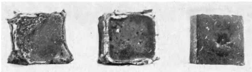
Abb. 47. Zementwürfel aus gewöhnlichem Portlandzement (links), hochwertigem Portlandzement (Mitte) und Tonerdezement (rechts) nach 60tägiger Lagerung in 15%iger Ammonsulfatlösung.
