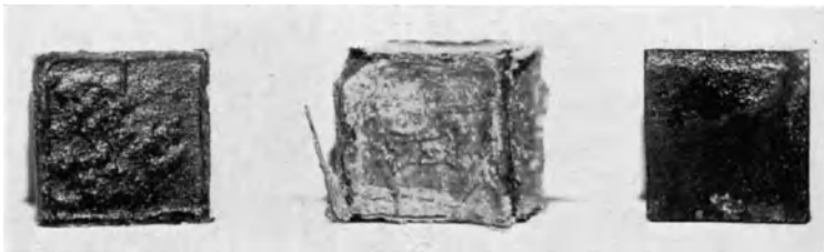
Abb. 55. Zementwürfel aus gewöhnlichem Portlandzement (links), hochwertigem Portlandzement (Mitte) und Tonerdezement (rechts) nach 536tägiger Lagerung in 15%iger Magnesiumsulfatlösung.
