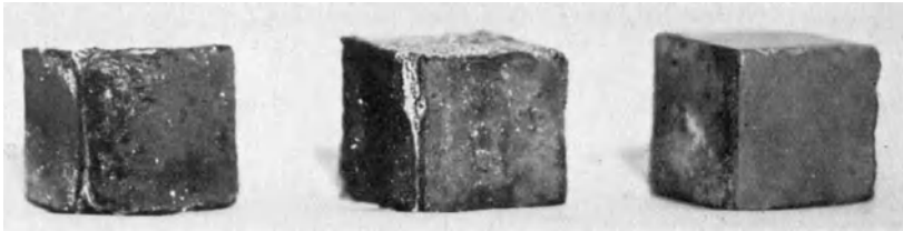
Abb. 46. Zementwürfel aus gewöhnlichem Portlandzement (links), hochwertigem Portlandzement (Mitte) und Tonerdezement (rechts) nach 20tägiger Lagerung in 15%iger Ammonsulfatlösung.
