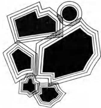
Abb. 1. Skizze des Abbindevorgangs.
