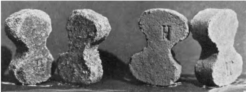
Abb. 67. Normenkörper aus hochwertigem Portlandzement nach einer Lagerung von 30 Tagen in 15%iger Ammonsulfatlösung. Links: 3 Körper in 4000 ccm Salzlösung, rechts: 24 Körper in 4000 ccm Salzlösung.
