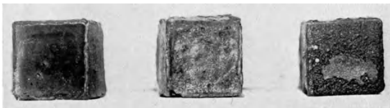
Abb. 53. Zementwürfel aus gewöhnlichem Portlandzement (links), hochwertigem Portlandzement (Mitte) und Tonerdezement (rechts) nach 536tägiger Lagerung in 15%iger Natriumsulfatlösung.
