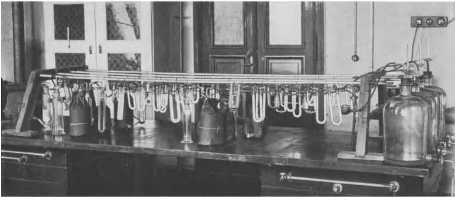
Abb. 10. Laboratoriumsapparat zur Messung der Bodenatmung.
