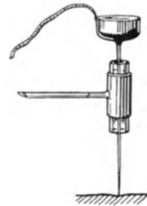
Abb. 56. Differente Elektrode zur Reizung der Schmerzpunkte. Die Elektrode sitzt stets mit gleichem Druck auf der Haut. Der Druck läßt sich durch Beladung der kleinen Schale mit Schrotkorn beliebig verändern. (v. FREY, Z. Biol. 76.)
