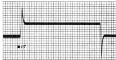
Abb. 18. Nachahmung mit der in Abb. 16 dargestellten Anordnung, C = 0,12 \mu F , w = 1000 Ohm, r = 10000 Ohm, V = 0,9 Volt. (Aus Pflügers Arch. 198.) (Nach W. EINTHOVEN und J. BIJTEL.)
