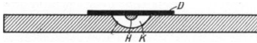
Abb. 4. Feuchte Kammer von R. KOCH. (Aus Enzyklopädie der mikrosk. Technik II. 1926.) D Deckglas. H hängendre Tropfen. K Kammer.
