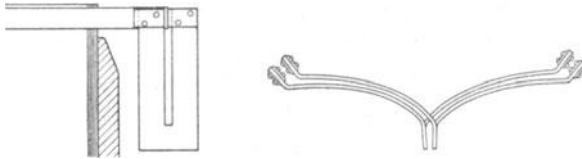
Abb. 111 a. Einschicht-Stabwicklung als Stirnwicklung.
