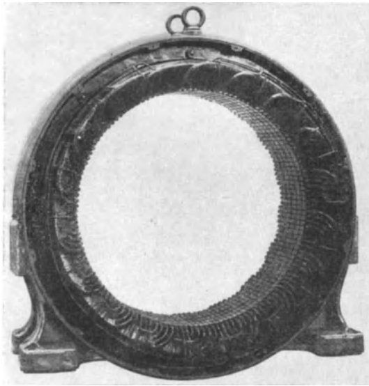
Abb. 177. Dreiphasenwicklung der A. E. G. mit zweifachen Wicklungsköpfen und gleichgeformten Spulengruppen (vgl. Abb. 176); p = 6 , q = 4 . Leistung 600 kVA.
