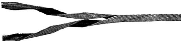
Abb. 249. Flach gepreßte Litze mit einer einzigen Faserschicht.
