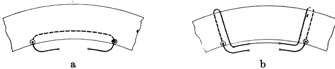
Abb. 341 a u. b. a) Mantelwindung. b) Vereinigung zweier Ringwindungen zur Mantelwindung.
