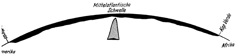
Abb. 64. a) Querschnitt durch den Atlantischen Ozean von Kap Hatteras (Amerika) nach Kap Verde (Afrika); die Tiefen sind 20mal übertrieben! b) Querschnitt durch den Hohen Meißner mit 20facher Übertreibung der Höhen (obere Linie) und im richtigen Verhältnis von Höhe und Länge (untere schwarze Fläche), zum Vergleich.
