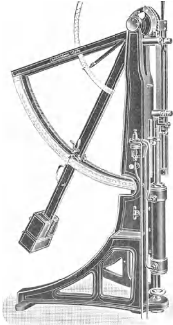
Fig. 104. Gewebe-Festigkeitsprüfer nach Schopper.
