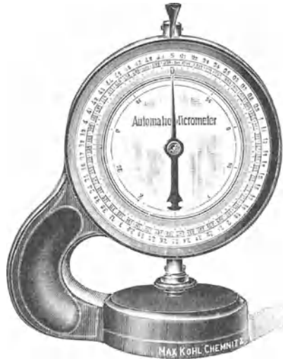
Fig. 84. Dickenmesser „Automatik“ (Schopper und Kohl).
