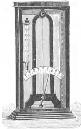
Fig. 63. Hygrometer nach Koppe.
