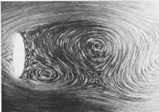
Abb. 64 bis 66. Strömung um einen zylindrischen Körper von elliptischem Querschnitt ( $b$  die große Achse der Ellipse).
