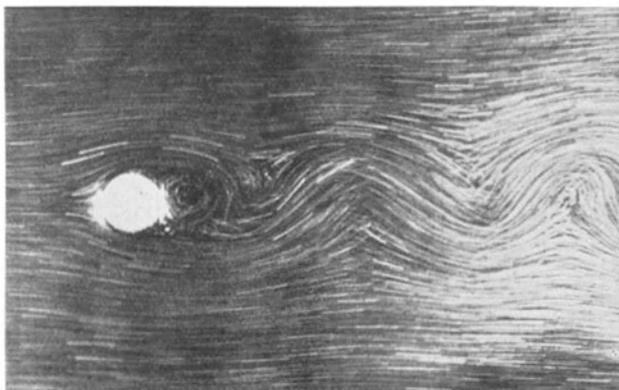
Abb. 59. Kármánsche Wirbelstraße;  $\frac{wd}{\nu} = 250$ . Das Bezugssystem (die Kamera) ist relativ zum umströmten Zylinder in Ruhe.
