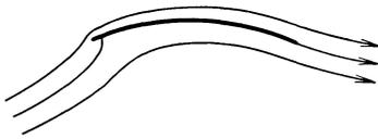
Abb. 148. Strömung um einen zur Anströmungsrichtung geneigten Kreisbogen (vgl. Abb. 141), bei der jedoch durch geeignete Wahl der Zirkulation der hintere Staupunkt an das Ende des Kreisbogens verlegt ist.
