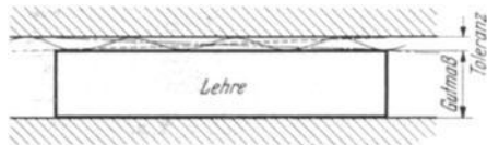
Abb. 55. Ausnutzung der Toleranz.
