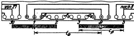
Abb. 231. Drehstrom-Dreilochwicklung zu Aufgabe 308.
