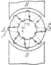
Abb. 79. Erläuterung zum Ringanker.
