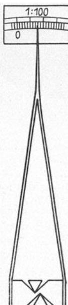
Abb. 61. Prinzip des Hirth-Minimeters, Fortuna-Werke, Stuttgart-Cannstatt.
