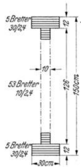
Abb. 22. I-förmiger, verleimter Querschnitt.
