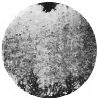
Abb. 48. Mikrophotographie eines Steinsalzkristalls nach heftiger Elektrolyse nach Lukirski.
