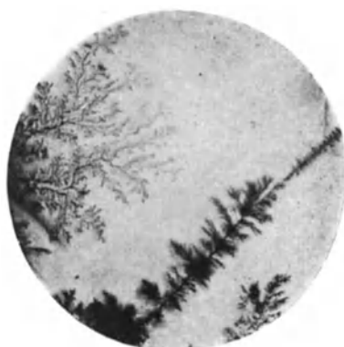
Abb. 49. Mikrophotographie eines Steinsalzkristalls nach Elektrolyse. Natriumdendrite an der Kathode nach Lukirski.
