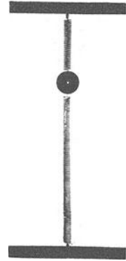
Abb. 78. Herstellung von Lissajous-Bahnen mit Hilfe elastischer Kräfte.
