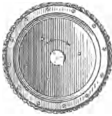
Abb. 52. Kette auf Schwungrad. Zur Veranschaulichung einer dynamischen Stabilität.
