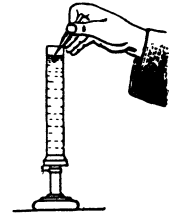
Abb. 109 Konstante Sinkgeschwindigkeit von Kugeln in Flüssigkeiten. Näheres in § 88.
