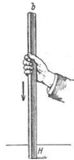
Abb. 34. Die äußere Reibung genannte Kraft ist am Stab angreifend nach unten, an der Hand angreifend, nach oben gerichtet. Pfeil gleich Gleitrichtung.
