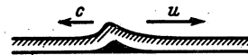
Abb. 535. Hydraulischer Wassersprung. Zur Veranschaulichung eines Verdichtungsstoßes in einem mit Überschallgeschwindigkeit strömenden Gase. Die Strömungsgeschwindigkeit u ist größer als die Geschwindigkeit c der Oberflächenwellen [Gleichung (198) v. S. 163]. Infolgedessen kann sich die bei dem Hindernis auftretende Störung nicht stromaufwärts bemerkbar machen.
