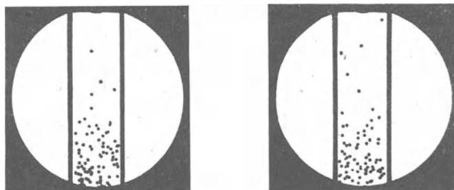
Abb. 240. Zwei Momentbilder eines Stahlkugelmodellgases zur Veranschaulichung der Barometerformel. Belichtungszeit je 8 \cdot 10^{-4} Sekunden.
