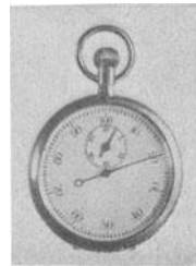
Abb. 18. Taschenstoppuhr mit \frac{1}{100} Sekunden-Teilung. Ein Umlauf gleich 1 Sekunde.
