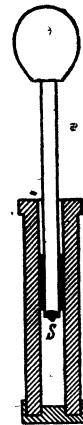
Abb 506. Eine aus Glas nachgebildete malayische Feuerpumpe. Statt des Schwammes S kann man am Boden des Stempels etwas mit Schwefelkohlenstoff angefeuchtete Watte anbringen. Dann führt die Verdichtungsarme zum Aufflammen des Luftdampfgemisches.
