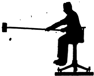
Abb. 129 Mit einem Holzklötzchen an einem langen Stiel lassen sich Drehimpulse mit verschiedenen Achsenrichtungen erzeugen.
