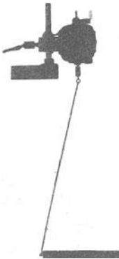
Abb. 134. Ein Stab umkreist die Achse seines größten Trägheitsmomentes als freie Achse.
