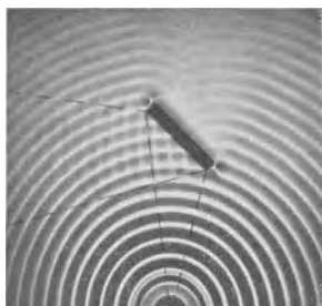
Abb. 380. Reflexion von Kreiswellen an einem Spiegel.
