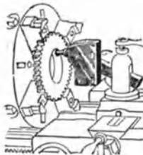
Fig. 99. Ausrichten eines Zahnrades mittels Fühlhebels auf der Planscheibe.
