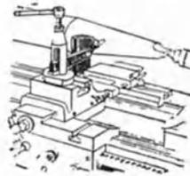
Fig. 100. Einstellen des Konuslineales nach einem Musterstück mittels Fühlhebels.
