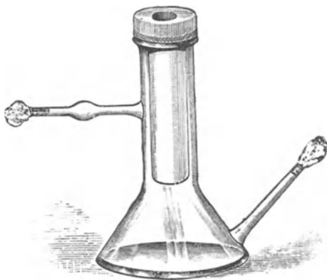
Abb. 61. Filtrierapparat nach Reichel.
