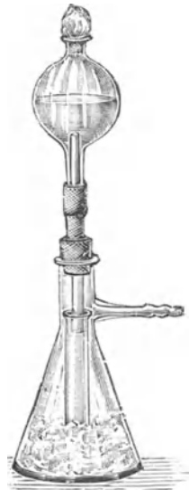
Abb. 62. Filtrierapparat nach Kitasato.
