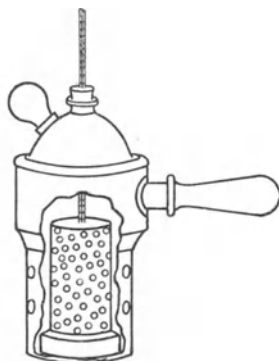
Abb. 67. Sterilisierbüchse mit Thermometer.
