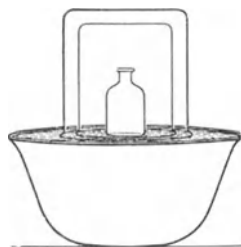
Abb. 68. Sterilisation auf Wasserbad mit aufgesetzten Bechergläsern.
