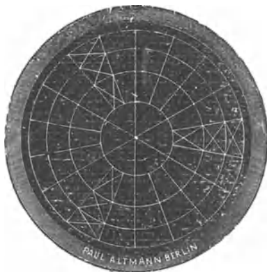
Abb. 14. Zählplatte für Petrische Doppelschalen nach LaFar.
