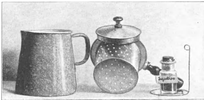
Abb. 65. Dampfbüchse für Rezeptur.
