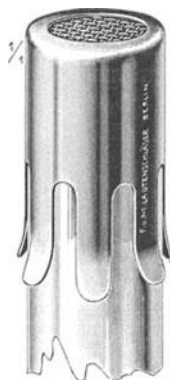
Abb. 91. Bakteriensicherer Verschluß für Reagensgläser.
