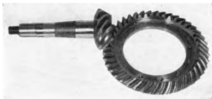
Bild 82. Kegelradschraubgetriebe mit rechtwinklig sich kreuzenden Achsen zum Antrieb der Hinterachse von Personenwagen.
