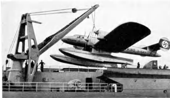
Bild 138. Flugzeugübernahmekran auf dem Motorschiff „Friesenland“, gebaut von der Firma Kampnagel Aktiengesellschaft, Hamburg 39. (Veröffentlicht mit Erlaubnis der Deutschen Lufthansa.)
