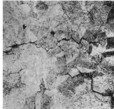
Abb. 161. Zwischenkristallin verlaufender Spannungsriß in \alpha -Messing. (Nach Moore, Beckinsale und Mallinson.)
