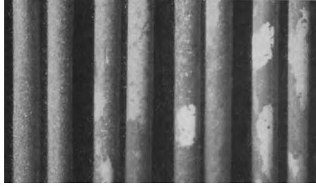
Abb. 77. Ausgeprägte Grobkristallisation bei einem Aluminium mittleren Reinheitsgrades (99,2% Al; 0,32% Si; 0,47% Fe).
