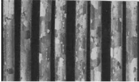
Abb. 76. Allmähliche Grobkristallisation bei sehr reinem Aluminium (99,9% Al; 0,07% Si; 0,04% Fe; 0,03% Cu).
