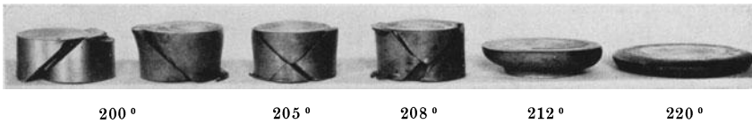
Abb. 111. Einfluß der Temperatur auf die Stauchbarkeit von Elektron. (Nach Schmidt.)
