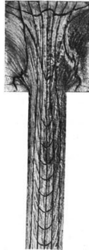
Abb. 190. Kupferstange aus Rundblock gepreßt. \frac{1}{8} nat. Größe.
