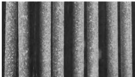
Abb. 78. Ausbleiben der Grobkristallisation bei einem verhältnismäßig unreinen Aluminium (99,1% Al; 0,47% Si; 0,40% Fe).
