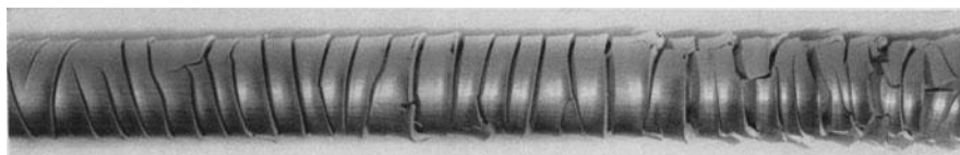
Abb. 199. Aufgerissene Preßstange in einer harten Aluminiumlegierung.
