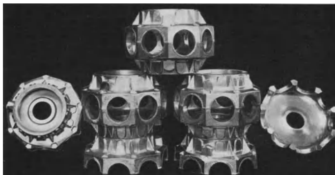
Abb. 212. Schmiederohlinge für Duralumin-Sternmotorgehäuse. Hersteller: Dürener Metallwerke.
