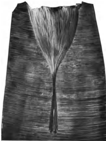
Abb. 193. Trichterbildung bei einem restlos verpreßten Messingblock. \frac{1}{10} nat. Größe.
