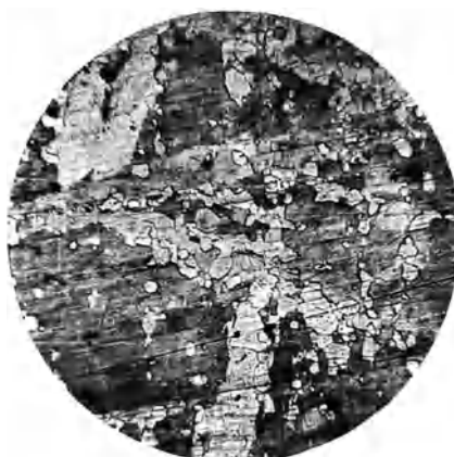
Abb. 62. Gefüge des grobkörnigen Zinnrohrs in Abb. 60.
