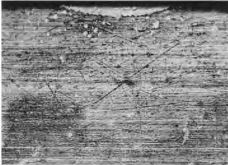
Abb. 202. Weißer Fleck auf einer Preßstange aus \beta -Messing mit 54% Kupfer. Vergr. 150 \times . Geätzt mit 10%igem (\text{NH}_4)_2\text{SO}_4 .
