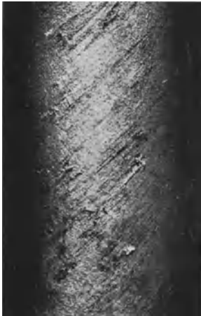
Abb. 102. Messingblech mit roten Flecken, beim Biegen als Schuppen abgeplatzt. Vergr. 6 ×.
