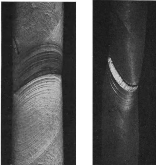
Abb. 35. Bruchbeginn bei einem einzelnen Messingkristall durch Gleitung auf mehreren Gleitsystemen.
