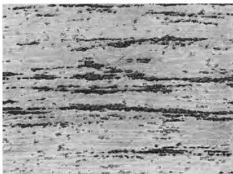
Abb. 23. Gestreckte Einschlüsse in einer Aluminiumlegierung. Vergr. 50×. Geätzt mit konz. \text{HNO}_3 + \text{K}_2\text{Cr}_2\text{O}_7 .
