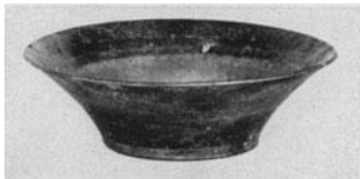
Abb. 112. In der Wärme gedrückte Schale aus einer bei Raumtemperatur spröden Kupferlegierung mit 8% Phosphor.
