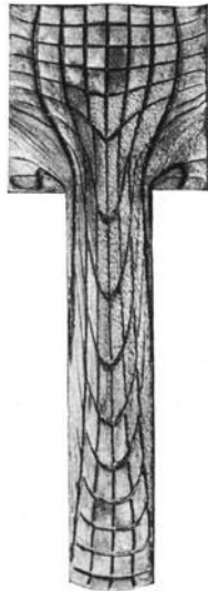
Abb. 189. Kupferstange aus Sechskantblock gepreßt. \frac{1}{8} nat. Größe.
