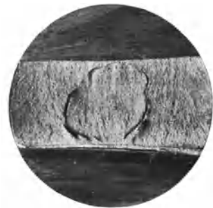
Abb. 192. Preßfehler durch Oxydeinschlüsse in einer Hartmessingstange infolge zu weiten Auspressens. Nat. Größe.
