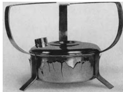
Abb. 158. Messingkocher, in Quecksilbernitratlösung aufgerissen.
