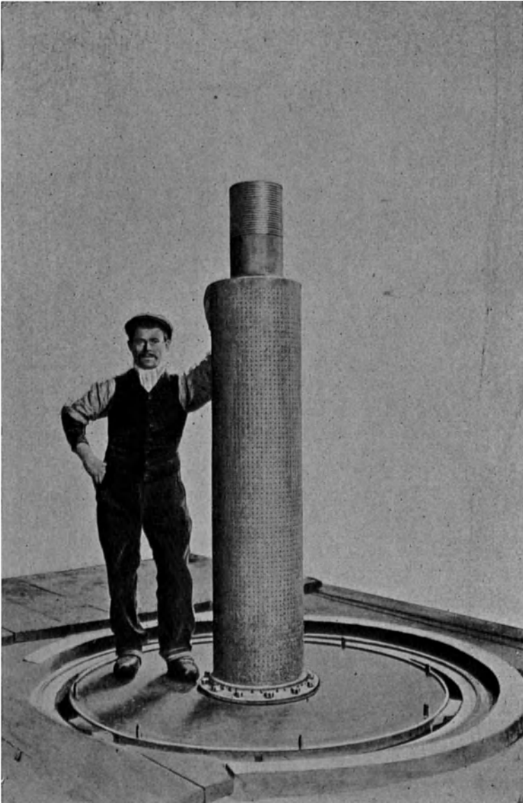
Fig. 94. Färbeapparat „Koloß“, Jean Schmitt, Belfort.
