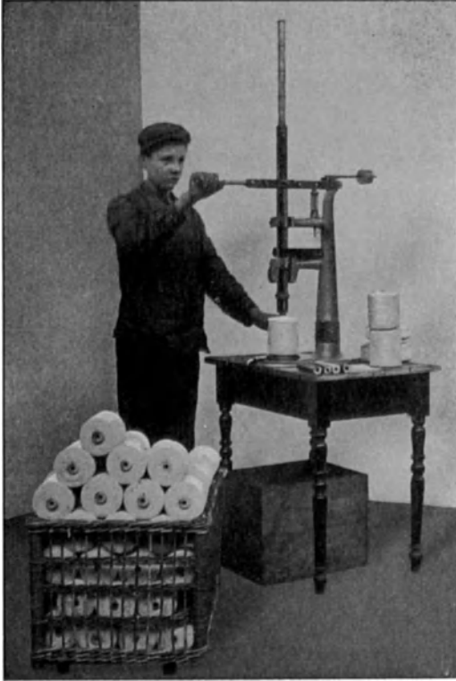
Fig. 75. Hülsen-Einschiebe-Apparat, System Cohnen,
