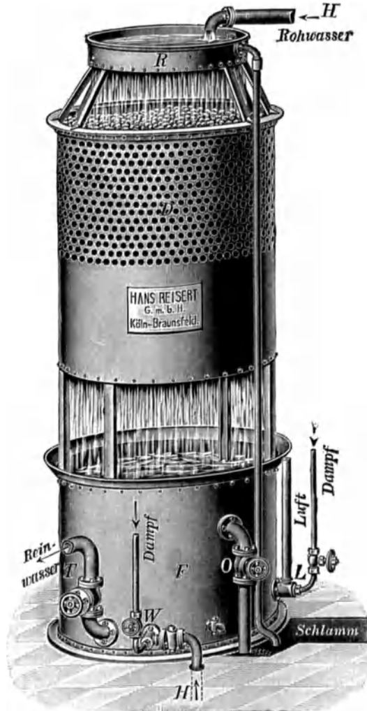
Fig. 13. Offener Enteisungsapparat, System Reisert.
