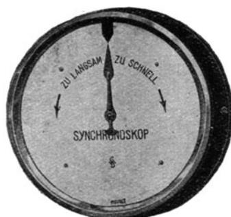
Fig. 40. Siemens-Synchronoskop mit umlaufendem Zeiger und fester Einstellung bei Synchronismus.
