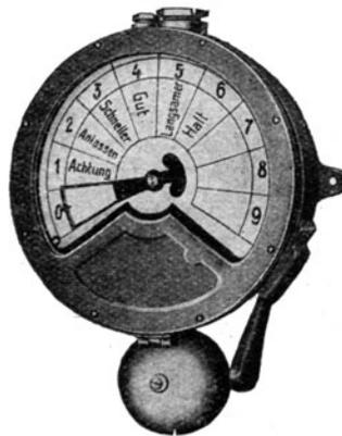
Fig. 93. Empfänger zum Zeiger-Befehlsapparat mit Sechsspulenmotor.
