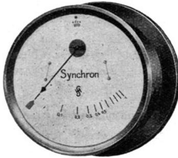
Fig. 27. Nullspannungsmesser für Dunkelschaltung mit Dreheisensystem und Vorschaltglühlampe, mit am Anfang besonders weit auseinander gezogener Skala.
