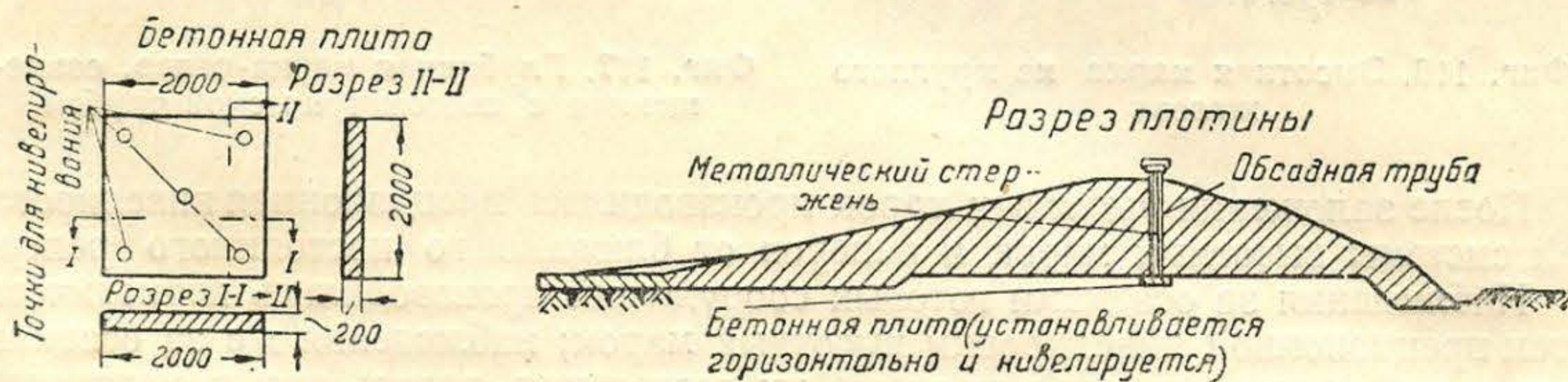
Фиг. 120. Глубинная марка для определения осадок оснований земляных плотин
