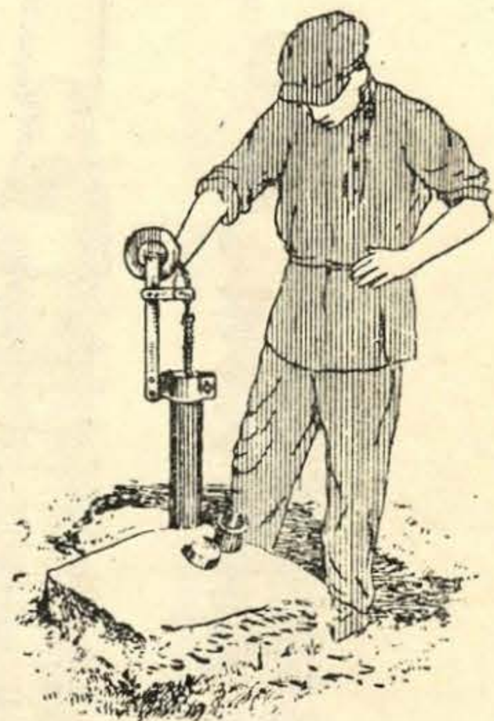
Фиг. 129. Общий вид пьезометрической скважины на земляных плотинах
