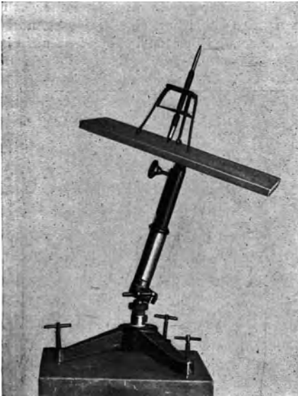
Abb. 32. Zeichentischchen, in verschiedene Ebenen einstellbar, zur Herstellung von Zeichnungen beliebig gerichteter Schnitte des Raumbildes.
