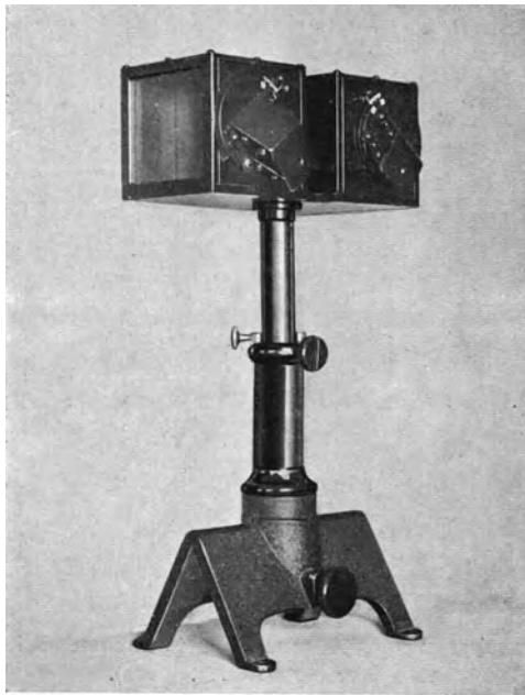
Abb. 36. Pulfrichs Stereokular zur Festlegung der individuell verschiedenen Augendistanz auf 8 cm. (Vgl. Abb. 35.)
