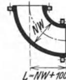
Abb. 127. Flanschkrümmer (DIN 2838). Q-Stück.
