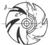
Abb. 75. Laufrad der selbstansaugenden „Ino“-Pumpe.
