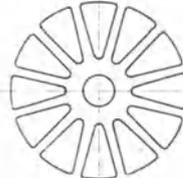
zeigt ein derartiges Ventil als Tellerventil (auch für größte Wassermengen als Ring- und als Mehrspaltventil ausführbar). Der besondere Vorteil dieser Konstruktion ist die zentrale Belastung des Ventils durch nur eine, entgegen allen anderen bekannten Systemen auf Zug
