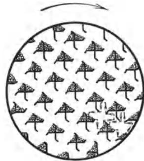
Abb. 43. Zelltrommeltrockner mit Kreuzeinbau.
