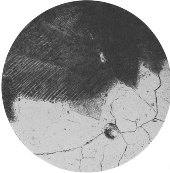
Abb. 25. Dünnschliff von Hochofenschlacke: Hochofenschlacke muß in glasiger Form dem Zement zugemahlen werden, da sie sonst kein Erhärtungsvermögen hat. Entglaste, also kristallisierte Hochofenschlacke dient nur als Betonzuschlag. Eisenportlandzement enthält 70% Schlacke, Hochofenzement bis zu 85% Schlacke. Auf dem Bild ist eine durch partielle schnelle Abkühlung teilweise glasig gewordene (unterer Teil), teilweise kristallisierte (oberer Teil) Hochofenschlacke dargestellt.
