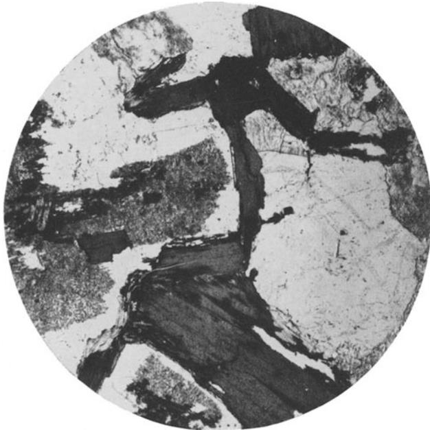
Abb. 6. Dünnschliff von Tiefengestein (Granit): Die einzelnen, den Granit aufbauenden Gesteine, wie Feldspat, Glimmer, sind deutlich zu sehen. Sie sind bei der langsamen Erstarrung, die sich über Jahrhunderttausende erstreckte, gut auskristallisiert und fest verkittet.
