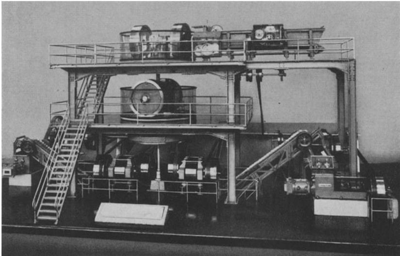
Abb. 48. Anlage zur Herstellung von Rohsteinen für Ziegel: Durch den Kastenbeschieber werden die richtig zusammengestellten Stoffe (Ton und Sand) dem Kollergang zugeführt, der sie knetet und durchmischt. Darauf passieren sie dann Walzwerke und werden den Ziegelpressen zugeführt, wo sie ihre Form erhalten. Leistung 250 cbm in 8 Stunden bei 200 PS Bedarf (Modell: Händle & Söhne, Mühlacker).
