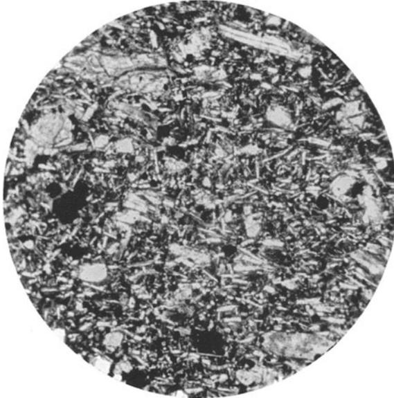
Abb. 28. Tonerdezement: Das Bindemittel unterscheidet sich wesentlich vom Portlandzement (S. 45). Tonerdezement besteht aus Calciumaluminiumsilikat, dessen Formel völlig anders ist als diejenige des Tricalciumsilikates aus dem Portlandzement.
