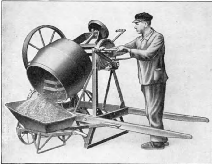
Abb. 139. Kleinmischer für Handbetrieb.
