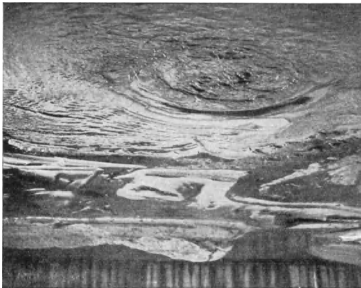
Abb. 215. Sandfördernde Quellen artesischen Wassers. (Nach Schonopp, Bautechnik 1926.)
