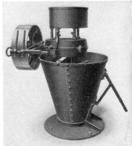
Abb. 141. Trichtermischer für Mörtel.
