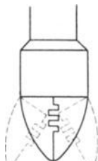
Abb. 65. Alligatorspitze des Simplexpfahles.
