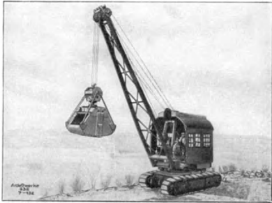
Abb. 54. Greiferkran auf Raupenkettens. (Ardeltwerke, Eberswalde.)
