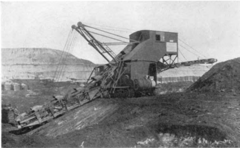
Abb. 102. Eimerketten-Tiefbagger auf Raupenbändern. (Lübecker Maschinenbaugesellschaft, Lübeck.)
