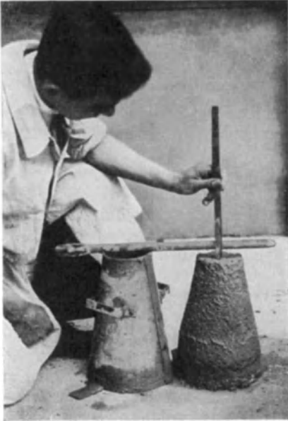
Abb. 13. Die Setzprobe. Messen des Plumpsmaßes. (Nach Grün.)
