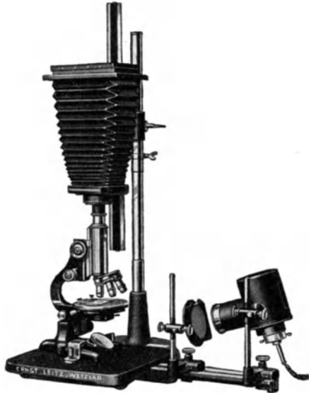
Abb. 358. Einfacher mikrophotographischer Apparat mit optischer Bank, Glühlampe und Filterträger (Plattenformat 9 × 12 cm).
