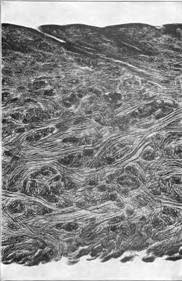
Abb. 282. Vertikalschnitt durch Kalbsleder (vegetabilisch gegerbt). Stelle der Entnahme: Schild. Dicke des Schnittes: 40 \mu . Färbung: keine. Gerbung: vegetabilisch. Okular: keins. Objektiv: 16 mm. Wratten-Filter: K 3-Gelb. Lineare Vergrößerung: 80-fach.
