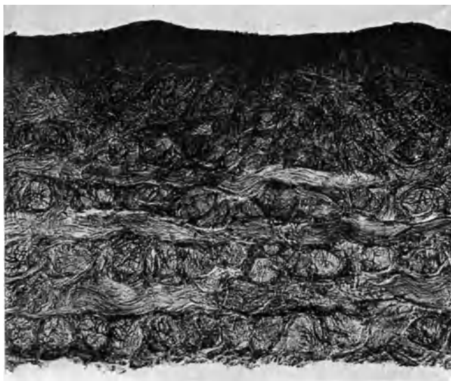
Abb. 379. Vertikalschnitt durch schwarzes Haifischoberleder.
