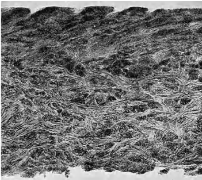
Abb. 377. Vertikalschnitt durch Kalbleder. (Ungefärbtes Bekleidungsleder.) Stelle der Entnahme: Schild. Dicke des Schnittes: 30\ \mu . Färbung: keine. Gerbung: pflanzlich. Okular: 5\times . Objektiv: 16 mm. Wratten-Filter: K 3 — Gelb. Vergrößerung: 75-fach.
