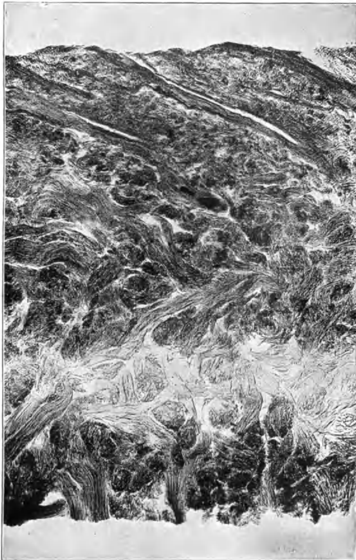
Abb. 285. Vertikalschnitt durch chromgares, nachgegerbtes Armee-Oberleder. Stelle der Entnahme: Schild. Dicke des Schnitts: 40 \mu . Färbung: keine. Gerbung: Chrom und vegetabilisch. Okular: keins. Objektiv: 16 mm. Wratten-Filter: K 3-Gelb. Lineare Vergrößerung: 54-fach.
