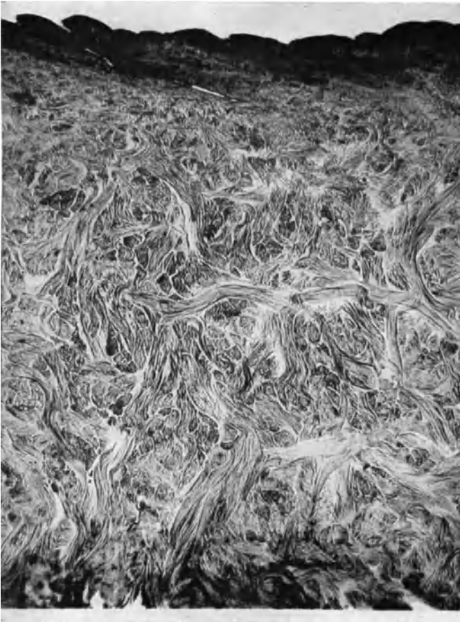
Abb. 380. Vertikalschnitt durch schwarzes Rindsoberleder. Stelle der Entnahme: Schild. Dicke des Schnittes: 30 \mu . Färbung: keine. Gerbung: Chrom. Okular: 5 \times . Objektiv: 32 mm. Wratten-Filter: K 3 — Gelb. Vergrößerung: 38-fach.
