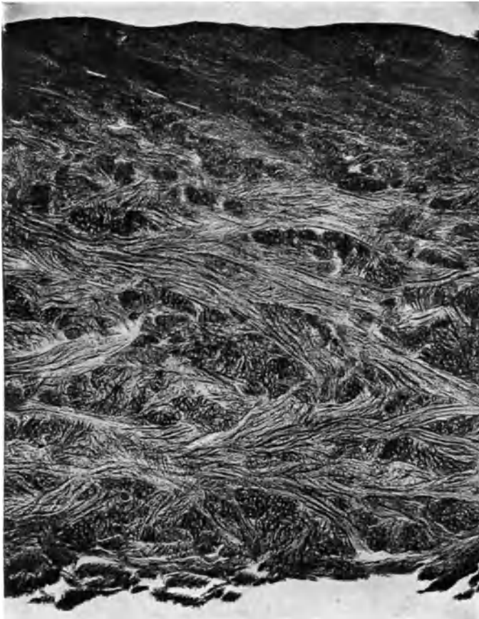
Abb. 369. Vertikalschnitt durch Kalbleder. (Gefärbtes, pflanzlich gegerbtes Oberleder.) Stelle der Entnahme: Schild. Dicke des Schnittes: 30 \mu . Färbung: keine. Gerbung: pflanzlich Okular: 5 \times . Objektiv: 16 mm. Wratten-Filter: K 3 — Gelb. Vergrößerung: 75-fach.
