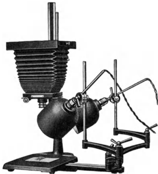
Abb. 359. Apparat auf optischer Bank mit Beleuchtungseinrichtung (Plattenformat 13 × 18 cm).
