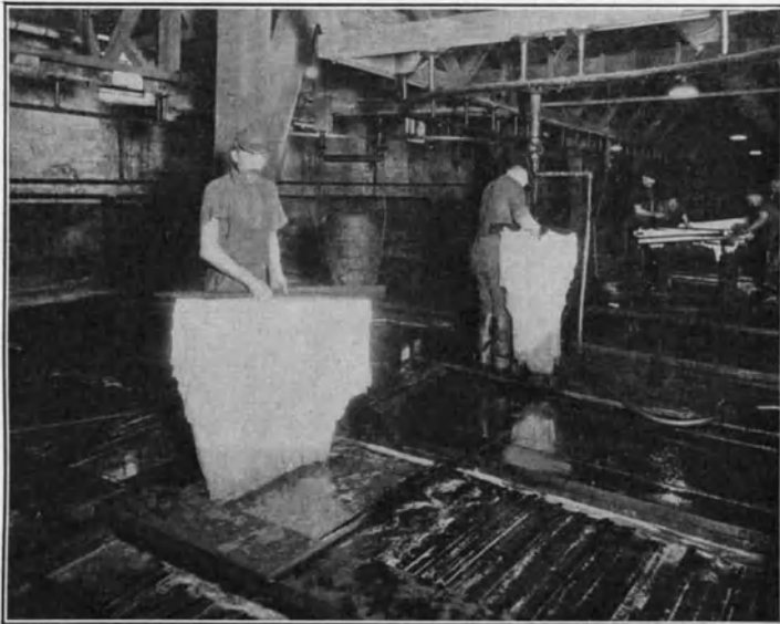
Abb. 203. Das Einhängen von Kalbsblößen in die Gerbbrühe.
