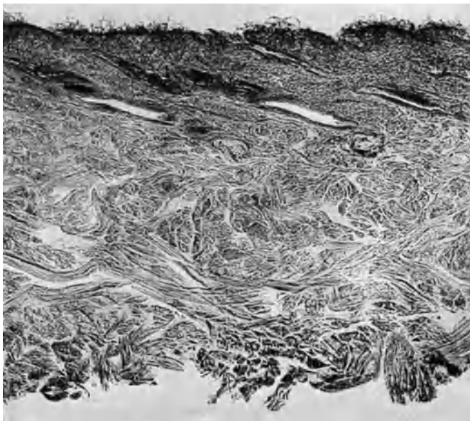
Abb. 374. Vertikalschnitt durch Rindsnarbenspalt mit abgepufftem Narben. Stelle der Entnahme: Schild. Dicke des Schnittes: 30\ \mu . Färbung: keine. Gerbung: Chrom. Okular: 5\times . Objektiv. 16\ \text{mm} . Wratten-Filter: K 3 — Gelb. Vergrößerung: 75-fach.
