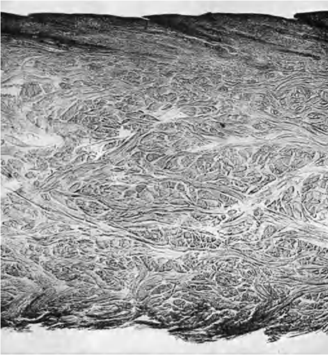
Abb. 370. Vertikalschnitt durch Kalbleder. (Gefärbtes, chromtares Oberleder.) Stelle der Entnahme: Schild. Dicke des Schnittes: 30 \mu . Färbung: keine. Gerbung: Chrom- Okular: 5 \times . Objektiv: 16 mm. Wratten-Filter: K 3 — Gelb. Vergrößerung: 75-fach.
