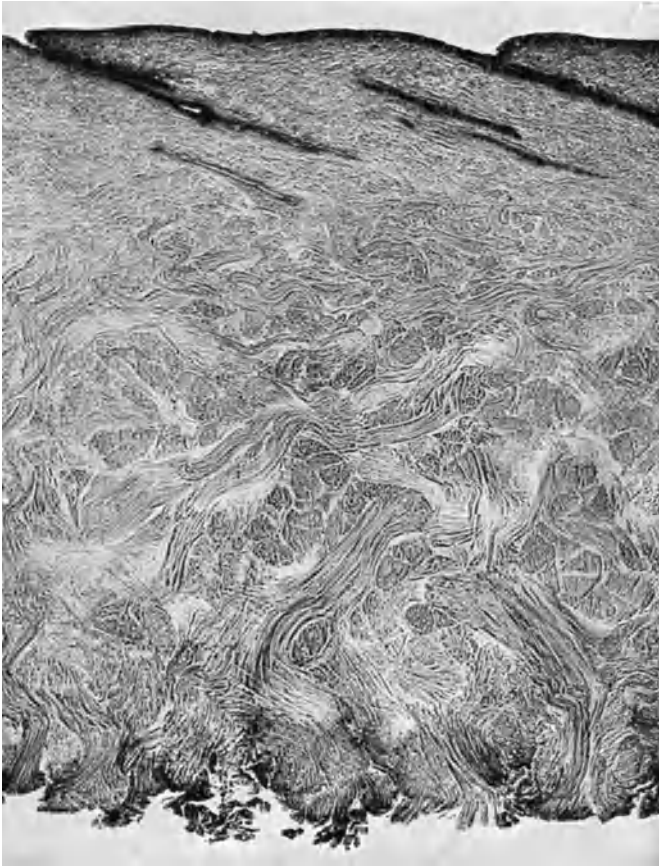
Abb. 375. Vertikalschnitt durch Rindsnarbenspalt mit intaktem Narben. Stelle der Entnahme: Schild. Dicke des Schnittes: 30\ \mu . Färbung: keine. Gerbung: Chrom. Okular: 5\times . Objektiv: 16 mm. Wratten-Filter: K 3 — Gelb. Vergrößerung: 75-fach.
