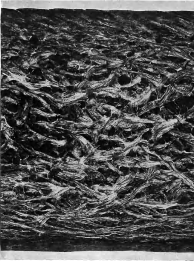
Abb. 382. Vertikalschnitt durch pflanzlich gegerbtes Sohlleder. Stelle der Entnahme: Schild. Dicke des Schnittes: 40 \mu . Färbung: keine. Gerbung: pflanzlich. Okular: keins. Objektiv: 32 mm. Wratten-Filter: K 3 — Gelb. Vergrößerung: 23-fach.
