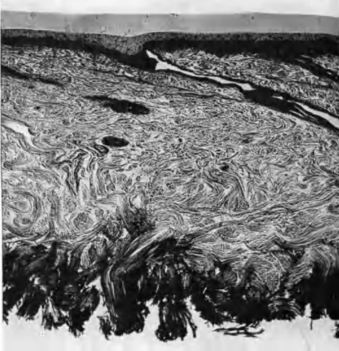
Abb. 339. Vertikalschnitt durch Rindlackleder.
