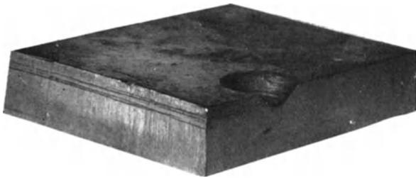
Bild 2. Doppelungen in der Probe 1 durch Durchblutung sichtbar gemacht
