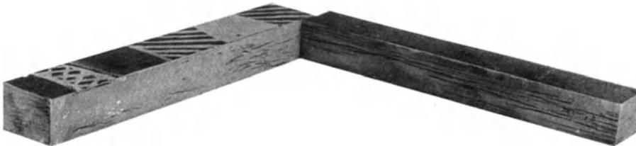
Bild 3. Ausdehnung der Doppelungen in und senkrecht zur Walzrichtung (Proben 6 und 5)
