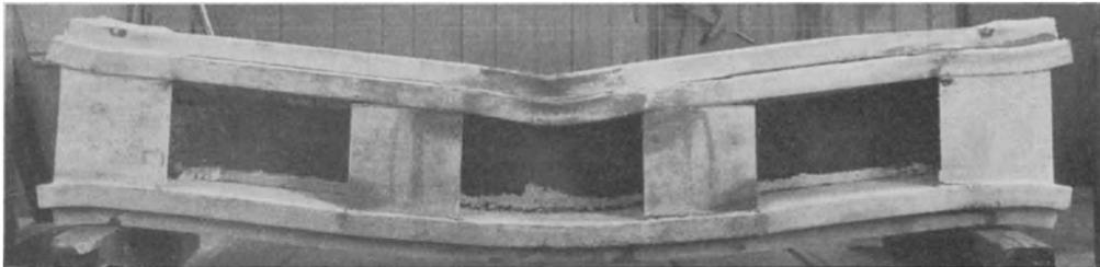
Bild 18. Biegeversuch mit dem Stützenstiel. Stütze nach dem Biegeversuch. Höchstlast 1186 t
