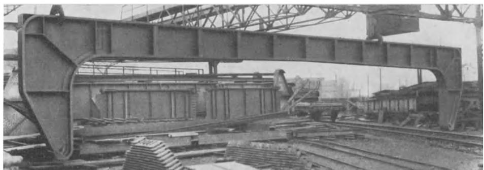
Bild 3. Werkaufnahme eines geschweißten Rahmens. (Vergleiche auch Fußnote 5)
