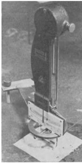
Bild 10. Ringaufspannung und Papierschablonen für elastische Dehnungsmessungen in 4 Richtungen mit Huggenberger-Tensometern zur Ermittlung des ebenen Spannungszustandes
