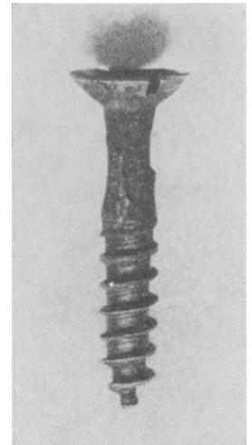
Bild 7. Schraube mit starkem Angriff am Schaft bei 2-jährigem Verweilen in Holz, das mit einem stark angreifenden Mittel (HBS 1) getränkt war ( $2 \times$ )
