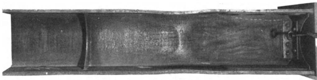
Bild 13. Ausbeulungen der Gurtplatten beim Druckversuch. (Nach der Höchstlast von 1100 t)
