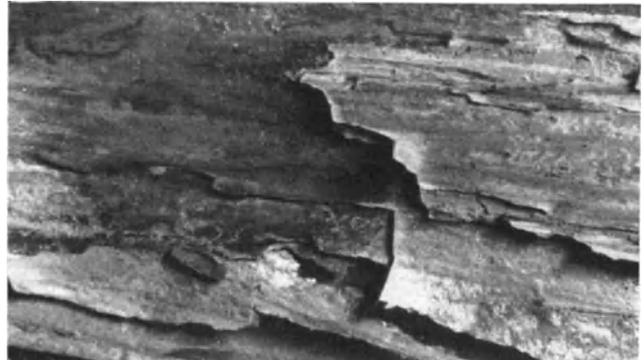
Bild 5. Abgehobene Doppelung, Probe 1,  $V = 3 \times$
