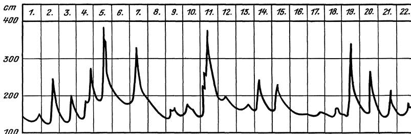
Abb. 304. Wasserstandsganglinie des Tji Anten bei Kradjak auf Java im September 1917.
