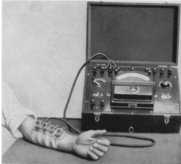
Abb. 1. Die 3 proximalen Elektroden dienen zur eigentlichen Messung. Die am weitesten distal gelegene als O-Elektrode. Für gewöhnliche Messung genügen 2 Näpfchen. Herstellung des Apparates durch die Firma Siemens-Reiniger, Erlangen.
