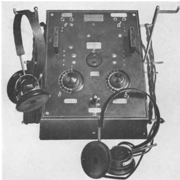
Abb. 10. Gerät zur HINSBERGSCHE Modifikation II des BLOCH-STENGERSCHE Versuchs. a Hebel zur Beschickung der beiden linken, der beiden rechten und aller Kopfhörer mit Sprechstrom; b , b , Rheostaten zur Regelung der Tonstärke in den linken bzw. rechten Kopfhörern; c Hebel zur Einschaltung des Summers; d Steckkontakte zur Einschaltung von Otoaudion oder Telephon unter Ausschaltung des Summers; e Steckkontakte zur Einschaltung eines Akkumulators an Stelle des Netzstromes. (Aus HINSBERG: Z. Hals- usw. Heilk. 32.)
