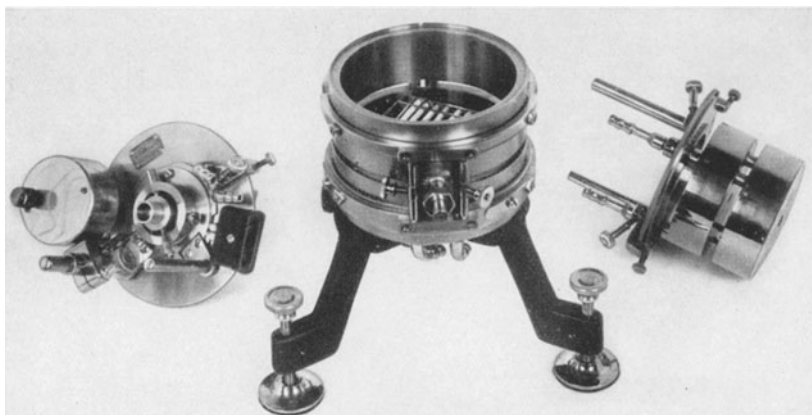
Abb. 178. Hochtemperaturkammer nach Seemann.
