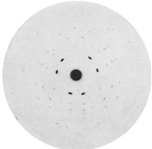
Abb. 185. Zinkblende in Richtung einer Würfelraumdiagonale durchstrahlt nach v. Laue, Friedrich und Knipping.
