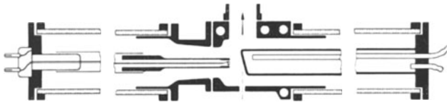
Abb. 23. Drei-Elektrodenröhre nach Seemann.
