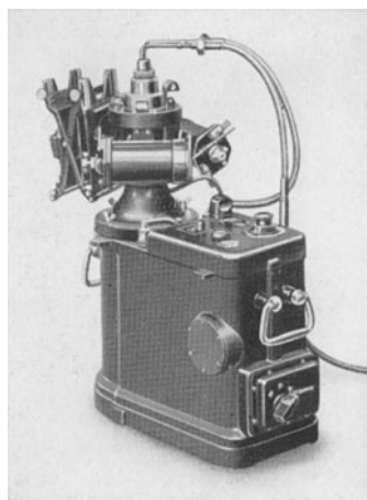
Abb. 174. Feinstrukturgerät nach W. E. Schmid.
