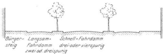
Abb. 26. Straße mit Schnellfahrdamm.
