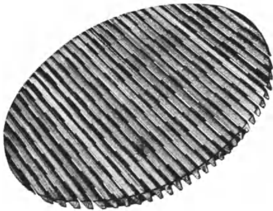
Abb. 59. Zwischenboden des hölzernen Extraktionsbottichs
