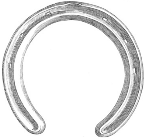
Fig. 70. Scharfseite eines Einfiedel'schen Winterreifens.
