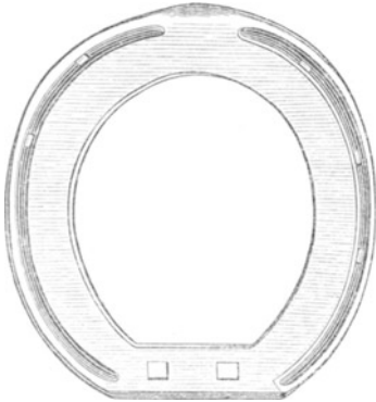
Fig. 66. Bodenfläche eines anderen geschlossenen Hufeisens.
