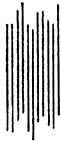
Abb. 10. Schema eines Molekülbündels im nematischen Zustande. Die fadenförmigen oder langgestreckten Moleküle liegen einander parallel, aber haben keine gittermäßige Ordnung.
