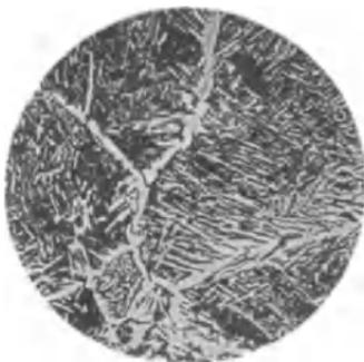
Fig. 9. Überhitzter Stahl.
