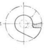
Fig. 26. Runder Formstahl, stark abgenutzt.
