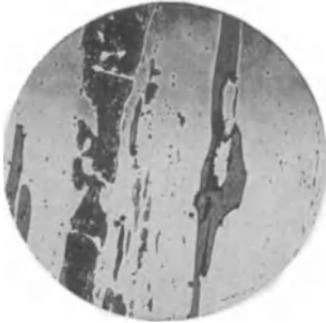
Fig. 1. Schlackeneinschlüsse.
