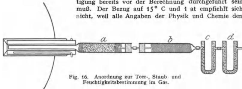
Fig. 16. Anordnung zur Teer-, Staub- und Feuchtigkeitsbestimmung im Gas.
