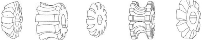
Fig. 88 u. 89. Formfräser für Werkzeugnuten.
