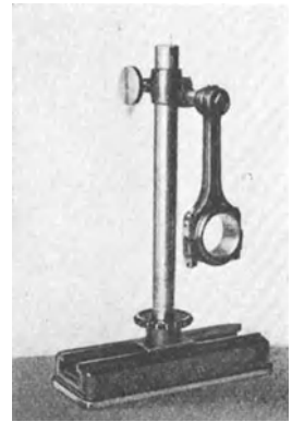
Abb. 14. Bestimmung des Massenträgheitsmomentes einer Pleuelstange.
