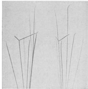
Abb. 49. Zusammenstoß eines \alpha -Teilchens mit einem Sauerstoffkern nach BLACKETT.
