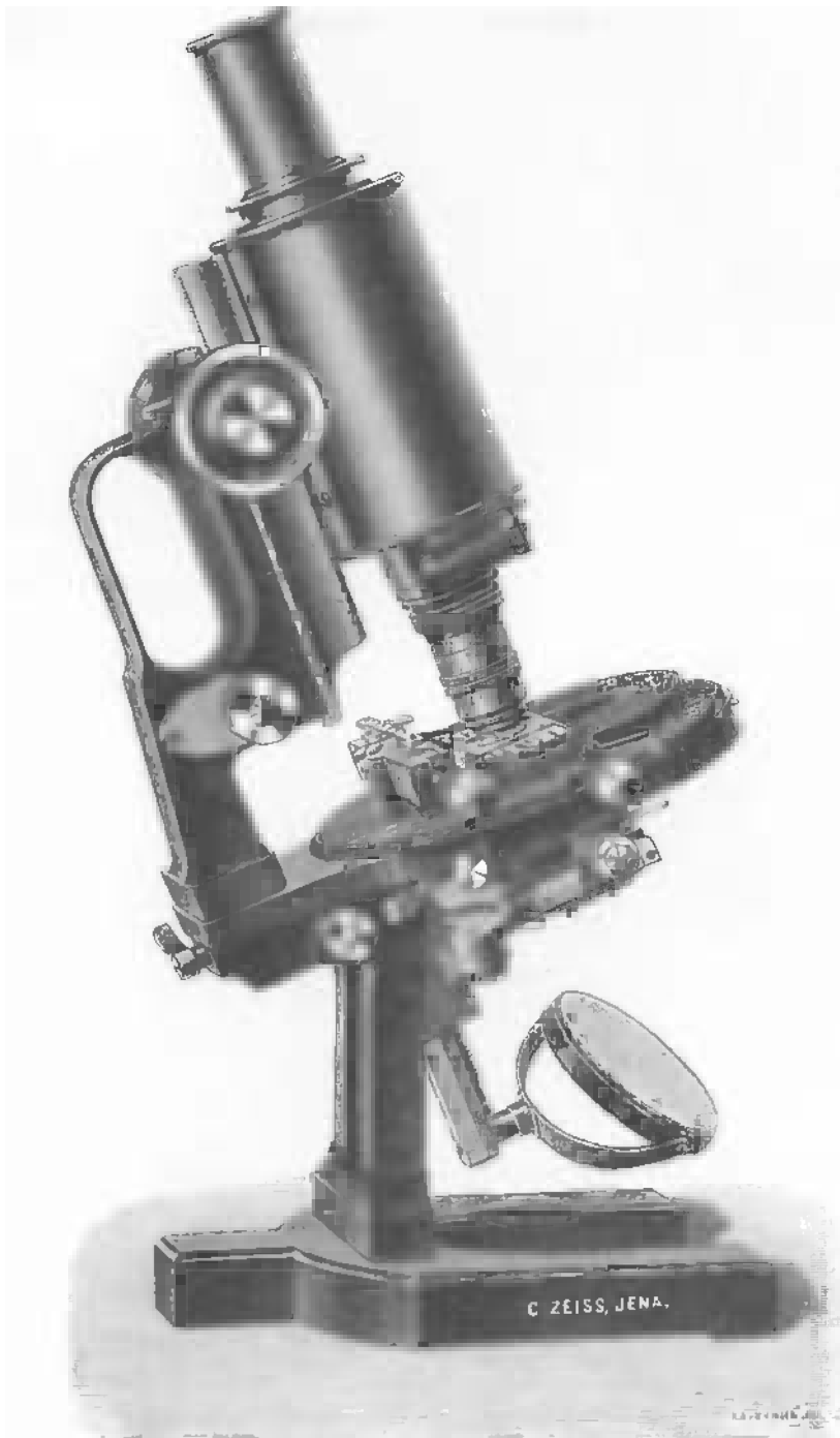
Großes Stativ, neue Form (für Mikrophotographie und Projektion).
