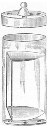
Trocken- u. Extraktionsgläschen von Ed. Spaeth.
